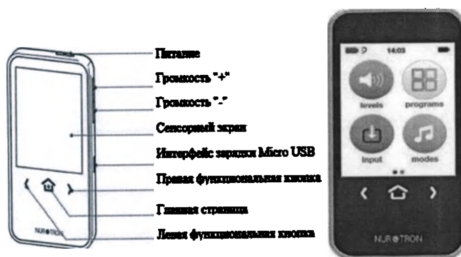
Рисунок 8. Схема наружной структуры дистанционного пульта управления
