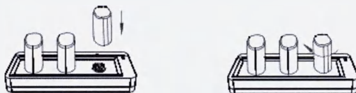
Рисунок 15. Соединение элементов аккумуляторного батарейного блока заушного типа ношения с зарядным устройством.
