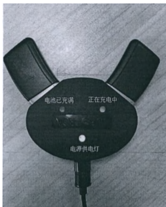
Рисунок 17. Состояние зарядки отсека аккумуляторного батарейного для заушного типа ношения
