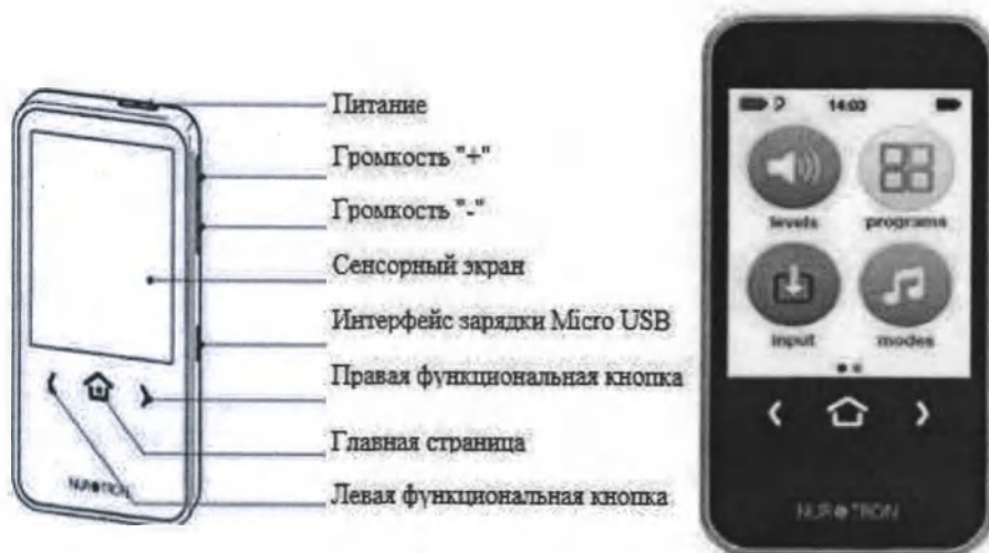
Рисунок 8. Схема наружной структуры дистанционного пульта управления
