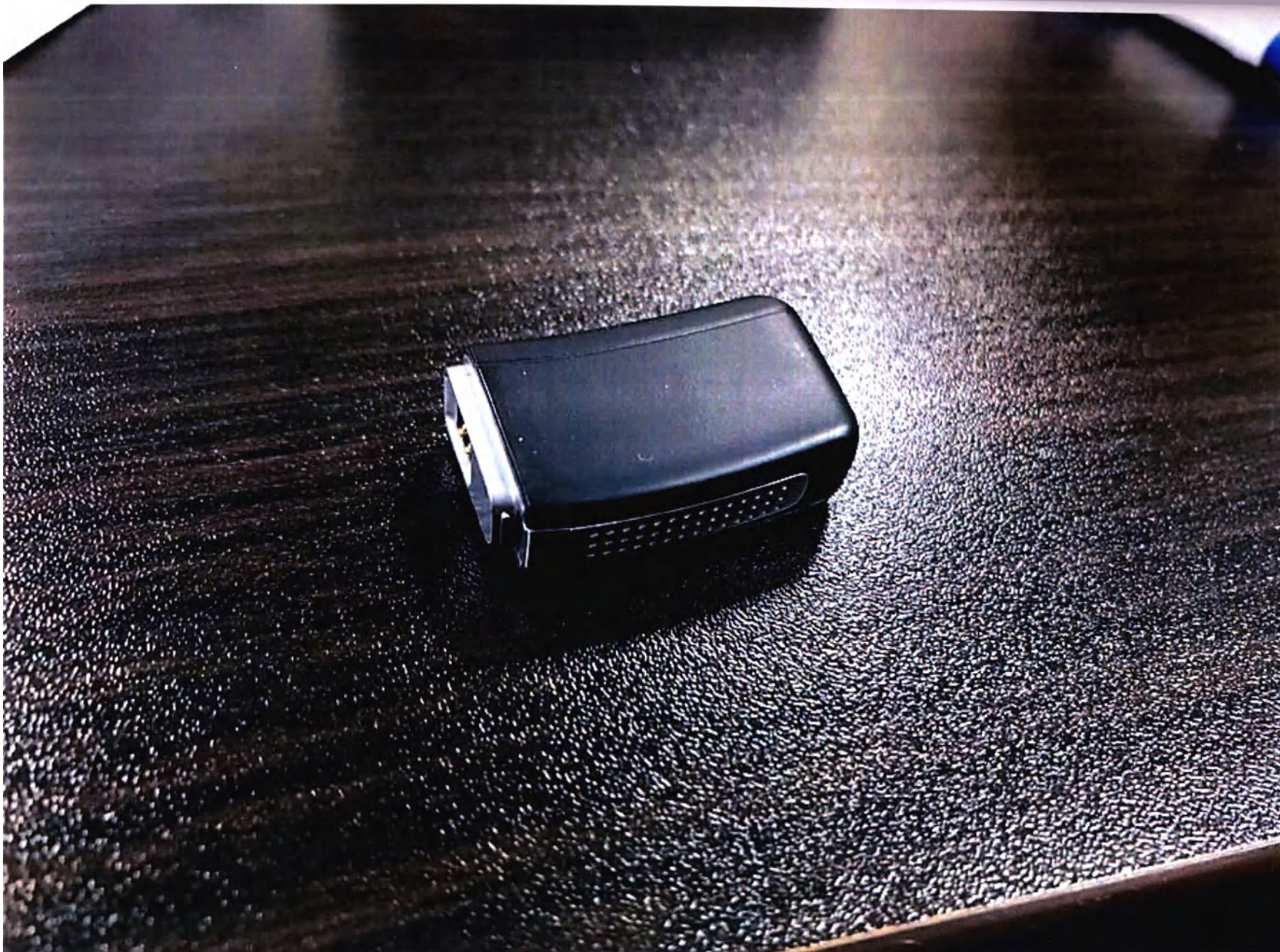
Отсек аккумуляторный батарейный для заушного типа ношения с интерфейсом
