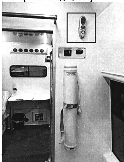
Рис.53 - Расположение пульта управления климатической установкой
