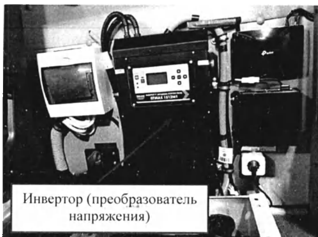
Рис.13 – Инвертор (преобразователь напряжения 12/220 В 1500 Вт) (за сиденьем водителя в кабине комплекса)
