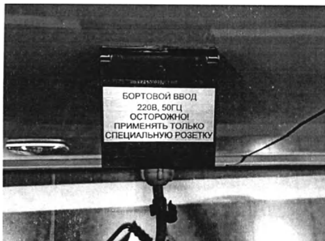
Рис.16 - Бортвой ввод (левый борт снаружи кузова комплекса)
