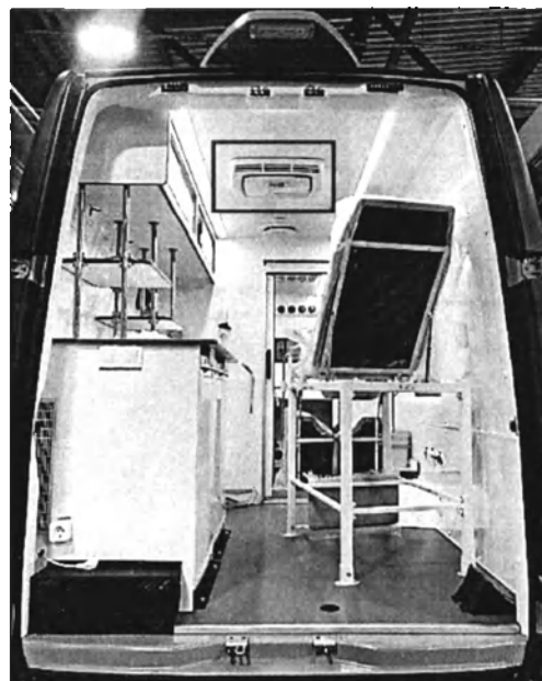
Рис.54 - Кондиционер на крыше в медицинском отсеке №2
