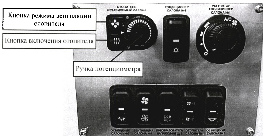
Рис.30 - Клавиши управления электрооборудованием в медицинском отсеке №1
