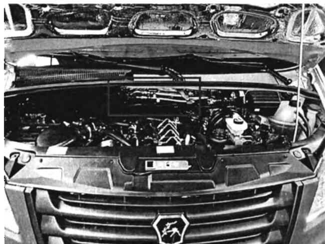
Рис.52 - Заправочные фитинги кондиционера в подкапотном пространстве
