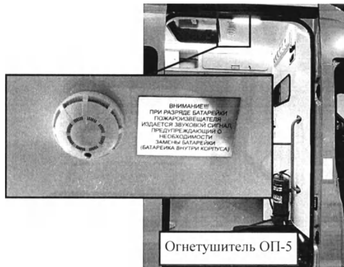
Рис.67 – Дополнительное оборудование медицинского отсека №1 (вид сбоку)
