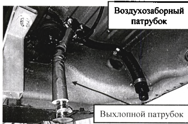
Рис.44 - Выхлопной и воздухозаборный патрубок автономного отопителя медицинского отсека №2 (расположен за столом во втором отсеке по левому борту)
