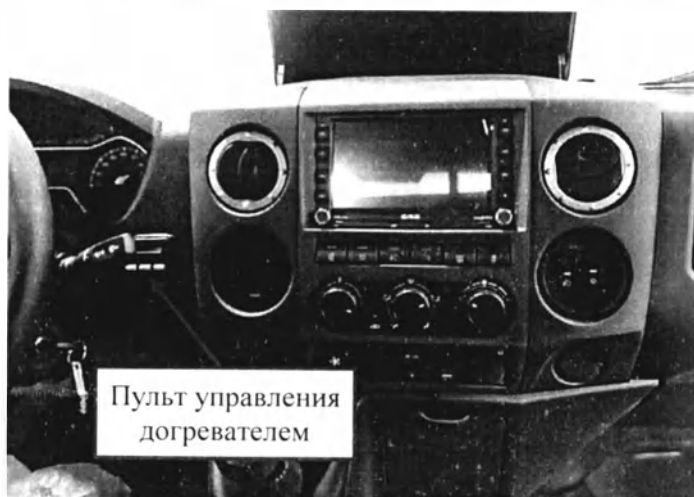
Рис.40 - Пульт управления догревателем/предпусковым подогревателем двигателя
