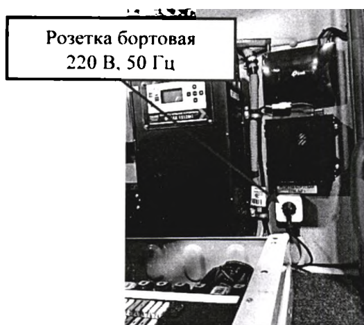
Рис.17 - Розетка бортовая в кабине комплекса за сиденьем водителя
