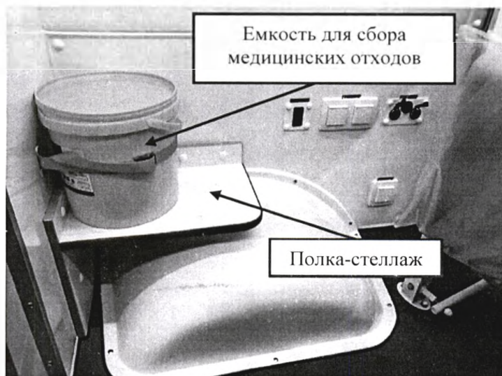
Рис.71 – Мебель и дополнительное оборудование медицинского отсека №2 (правый борт)
