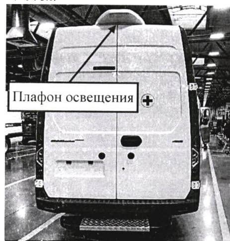
Рис.33 - Плафон освещения задних распашных дверей комплекса
