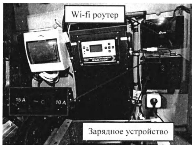
Рис.24 - Зарядное устройство (ЗУ) на перегородке в кабине комплекса за сиденьем водителя
