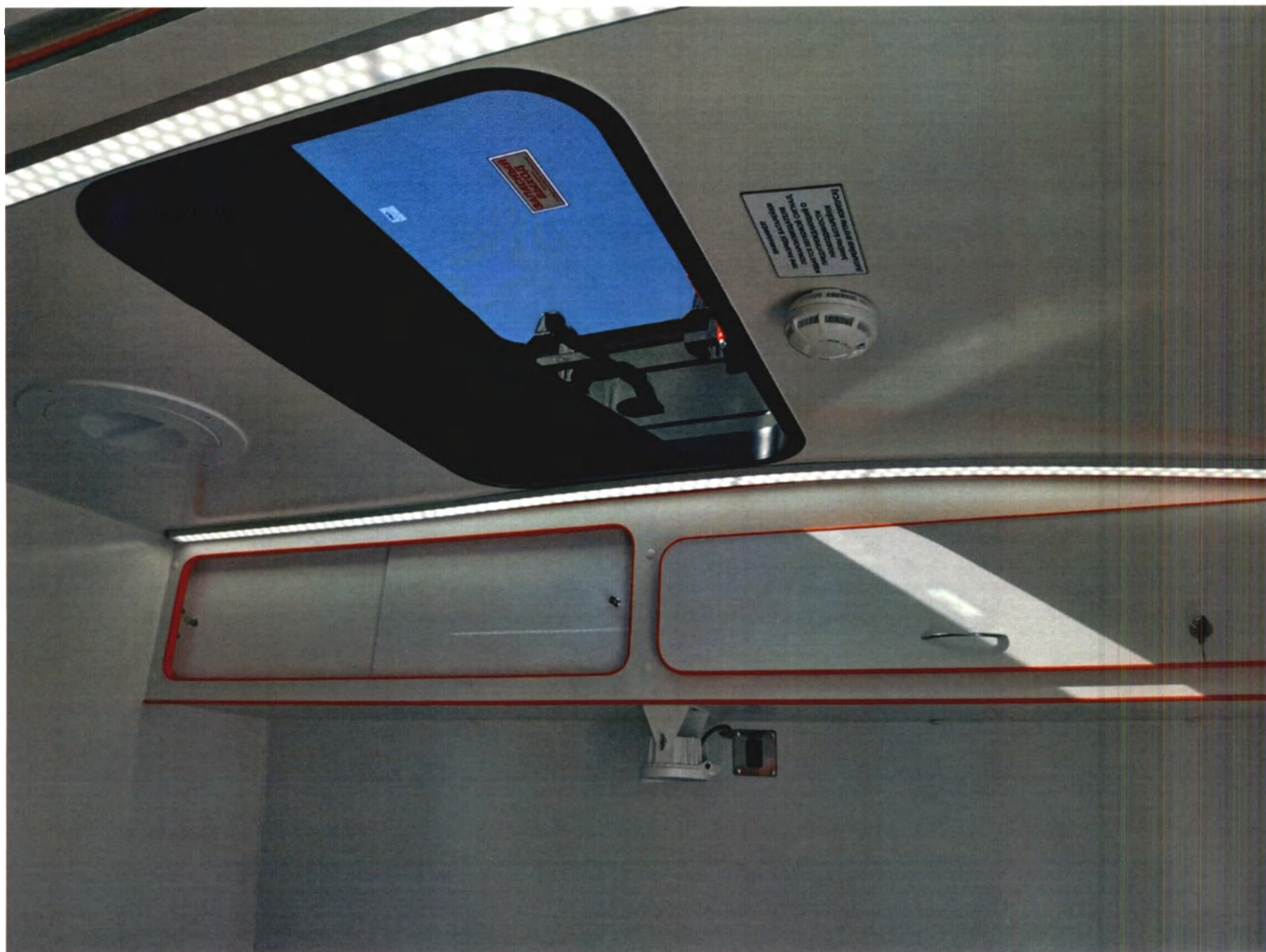
Рисунок 6 медицинский отсек. Потолок с люком увеличенной высоты.
