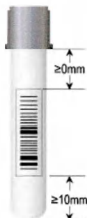
Рисунок 12.2 Способ наклеивания этикеток со штрихкодом пробы
