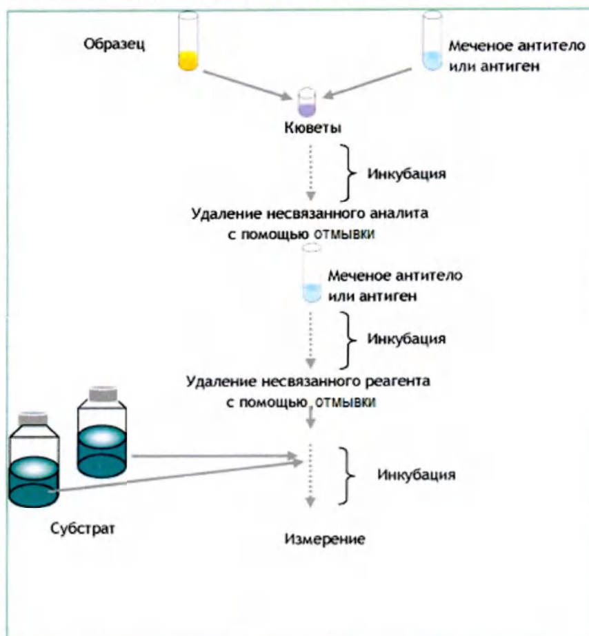
Рисунок 4.5 Двухстадийный метод с двумя отмытками
