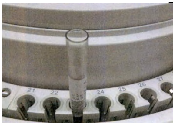
Рисунок 2.17 Штрихкоды пробирок должны смотреть наружу
