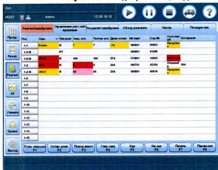
Рисунок 5.5 Флаг для реагентов, загруженных вручную
