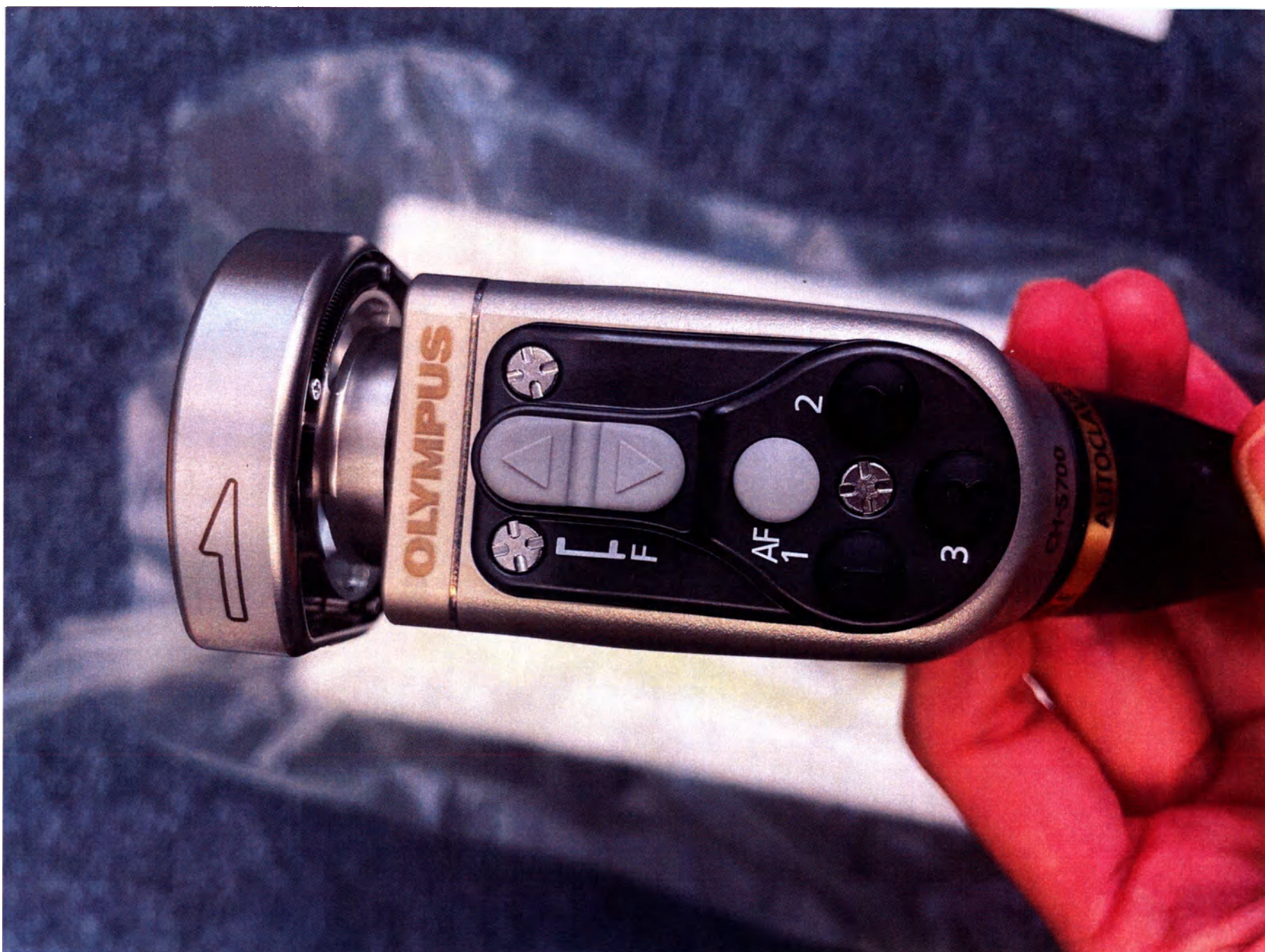
Рис. 4. Головка видеокамеры CH-S700-XZ-EA – органы управления.
