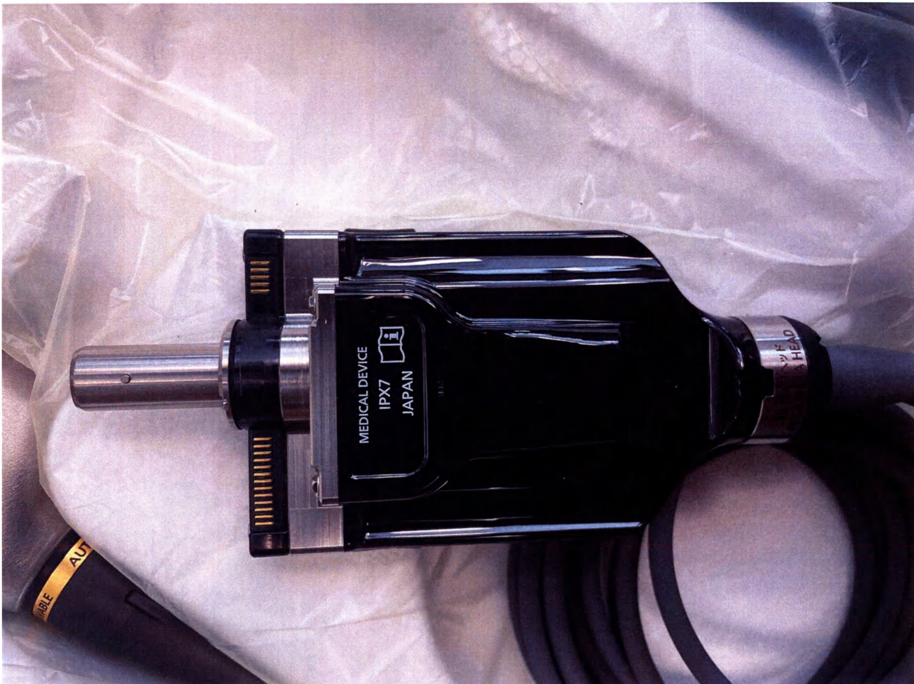
Рис. 5. Головка видеокамеры CH-S700-XZ-EA – маркировка на разъеме.
