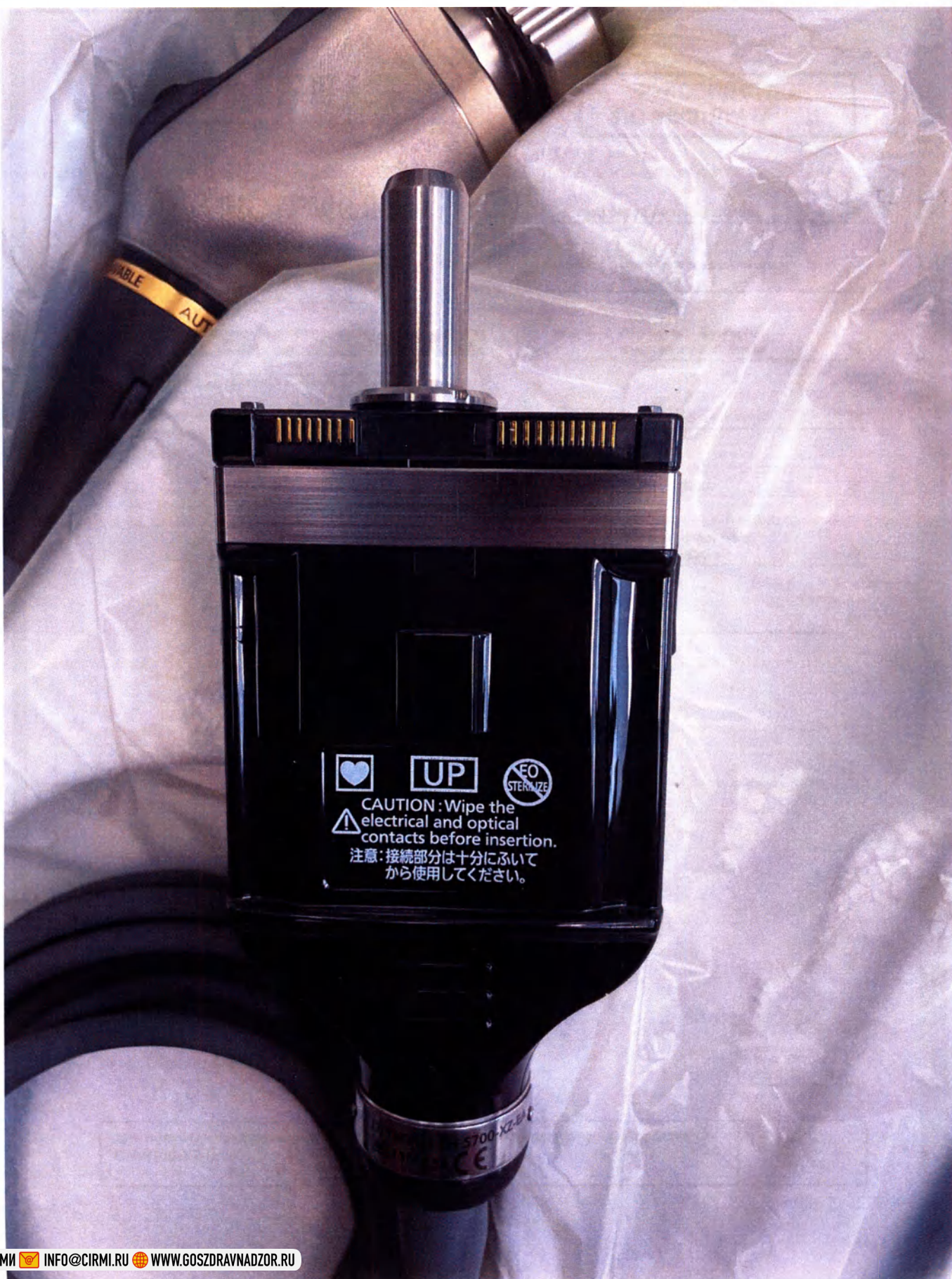
Рис. 6. Головка видеокамеры CH-S700-XZ-EA – маркировка на разъеме.
