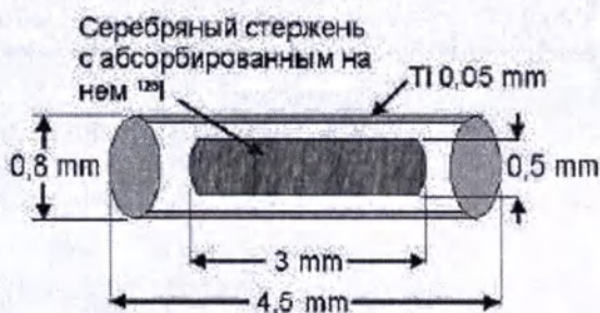
Схематическое изображение зерна с радионуклидом йод-125
