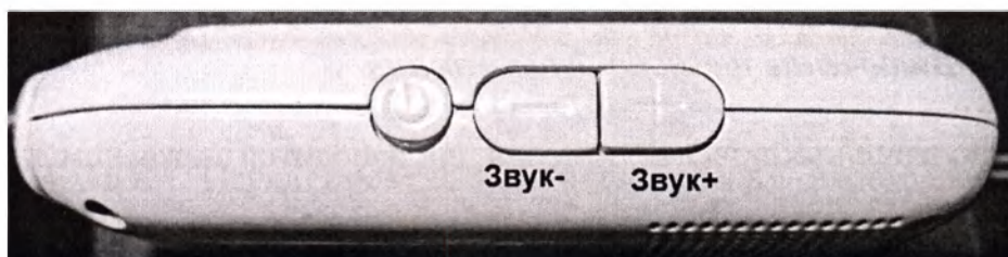
Рисунок 2.2 – Элементы управления мобильного регистратора «Илифия-Д»
