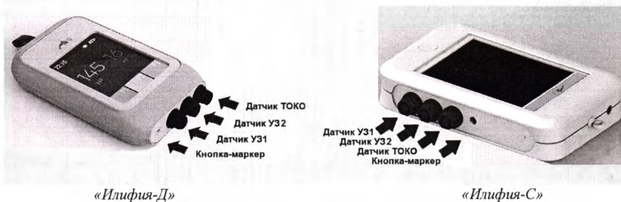
Рис. 2. Подключение датчиков и маркера шевелений плода к МР
