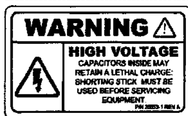
Рисунок D-16. ПРЕДОСТЕРЕЖЕНИЕ: Высоковольтные конденсаторы
