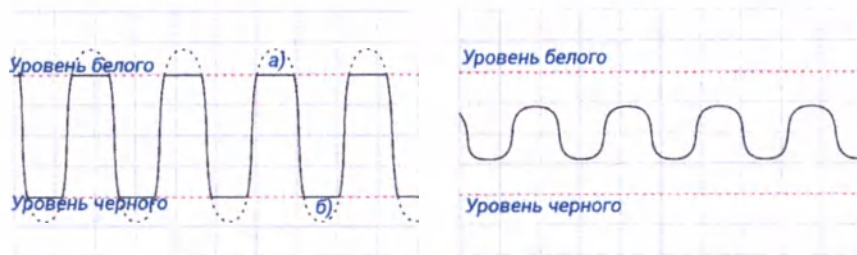
Рисунок 15. Регулировка контрастности видеосигнала. а) потеря части информации о светлых участках изображения; б) потеря части информации о темных участках изображения.
