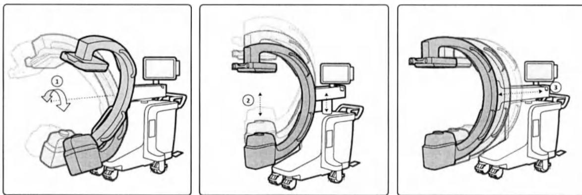
Рис. 44 Перемещение С-дуги относительно 3 осей
