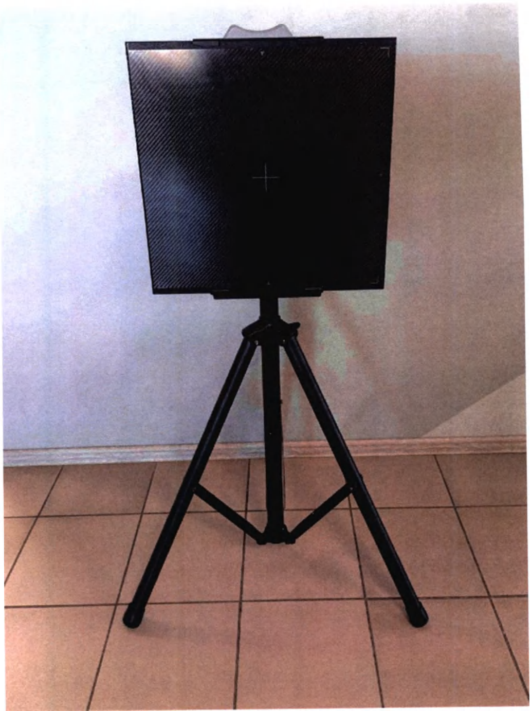
Фото 35. Плоскопанельный детектор модели PIXX 1717 на штатив RMD-GMMB05 для плоскопанельного детектора PIXX 1717
