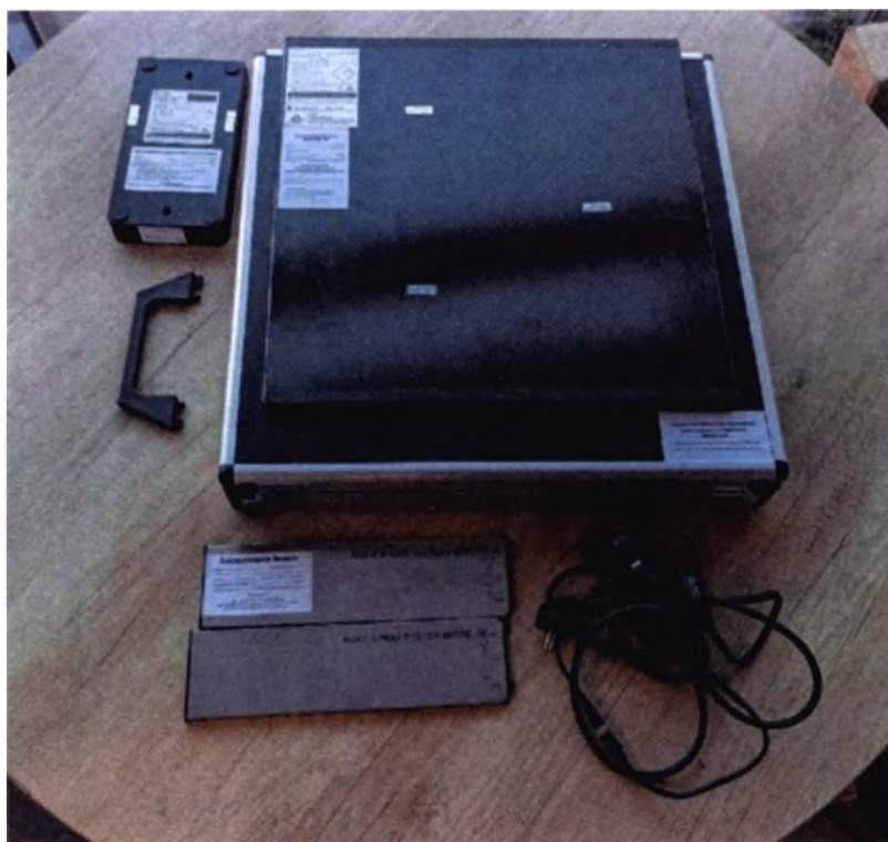
Фото 20. Общий вид плоскостанельного детектора PIXX 1717с принадлежностями
