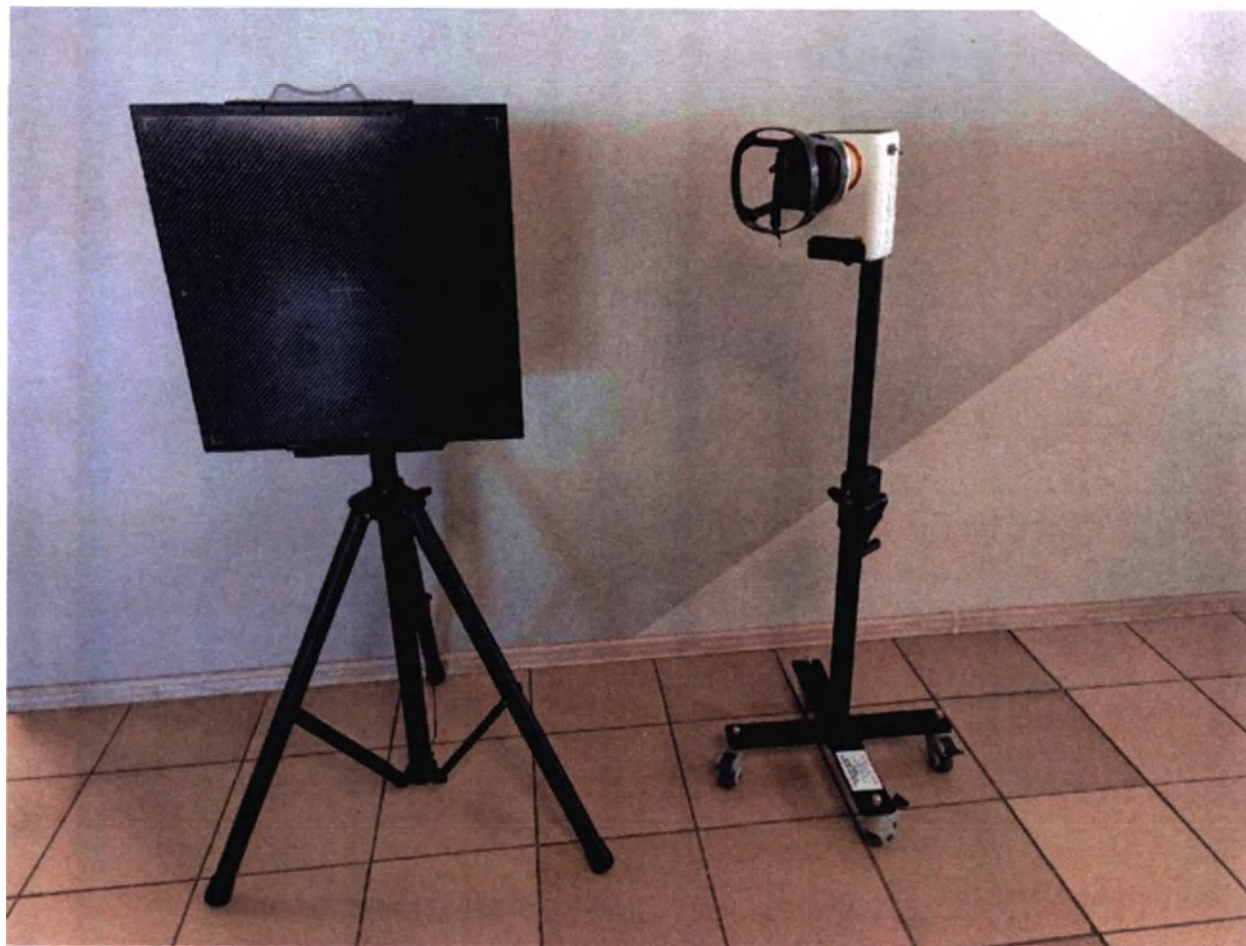
Фото 32. Плоскопанельный детектор модели PIXX 1717 на штатив RMD-GMMB05 для плоскопанельного детектора PIXX 1717, Аппарат рентгеновский портативный REMEX-КА6 на штативе RMD-GMMB20 для аппарата рентгеновского портативного REMEX-КА6
