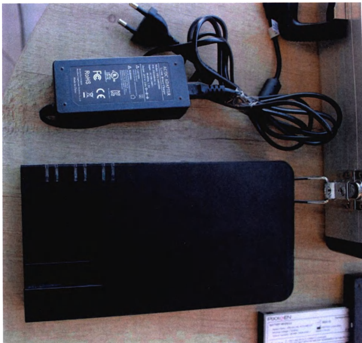
Фото 30. Док-станция для зарядки аккумуляторных батарей с зарядным устройством
