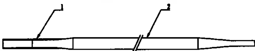
Рисунок 4. Конструкция удлинителя, где 1 – втулка; 2 – мандрен
