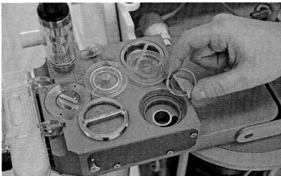
Рисунок 58 – Разборка элементов клапана выдоха
