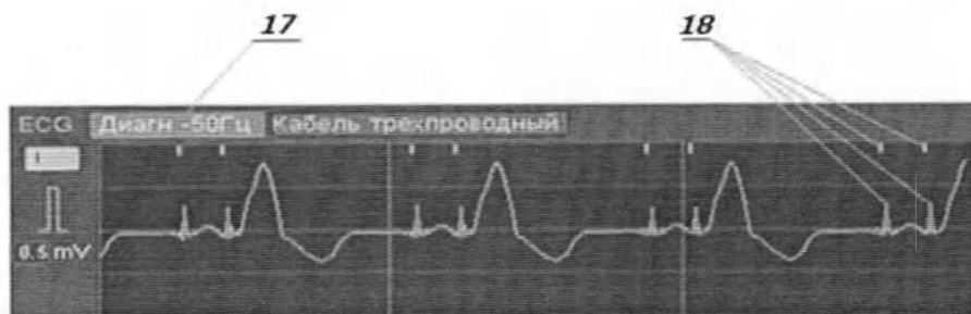
Рисунок 40 – Положение импульса кардиостимулятора (обозначения в таблице 19)
