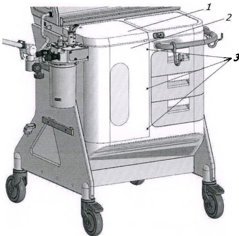
1 – крышка блока ИВЛ, 2 – панель блока ИВЛ, 3 – винты
