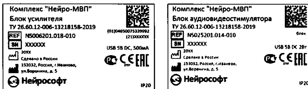
Рис. 13. Образцы маркировки электронных блоков комплекса
