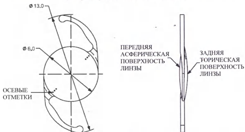
Рисунок 1: Физические характеристики торической ИОЛ AcrySof IQ (Все размеры указаны в миллиметрах)
