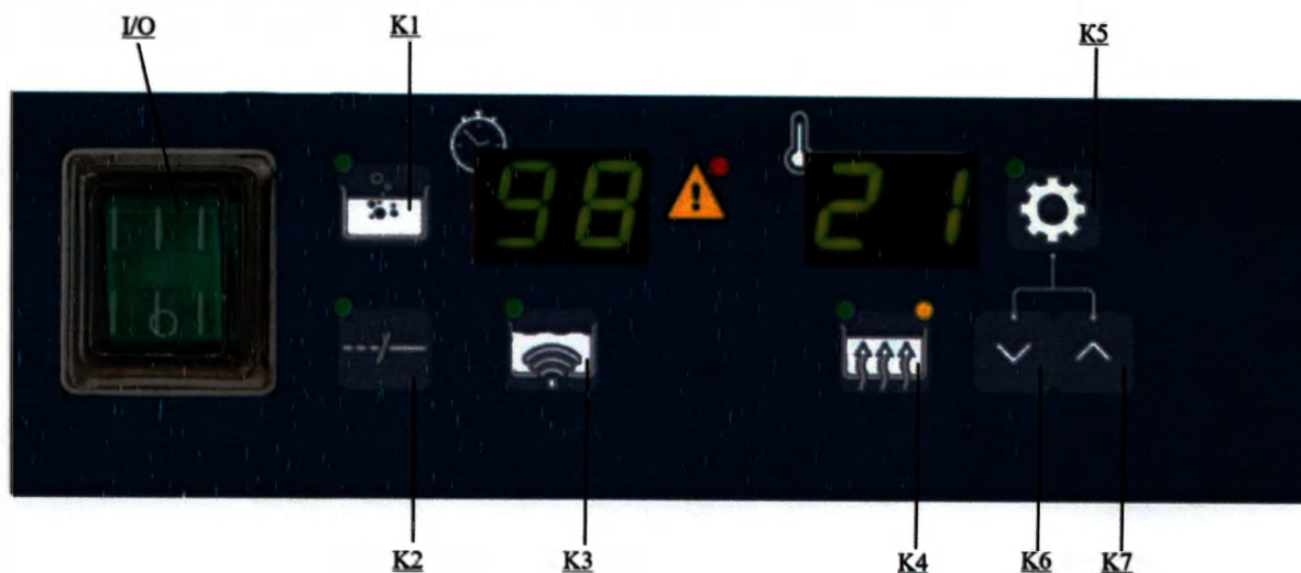
Рисунок 3.1. Описание передней панели управления. Кнопки.
