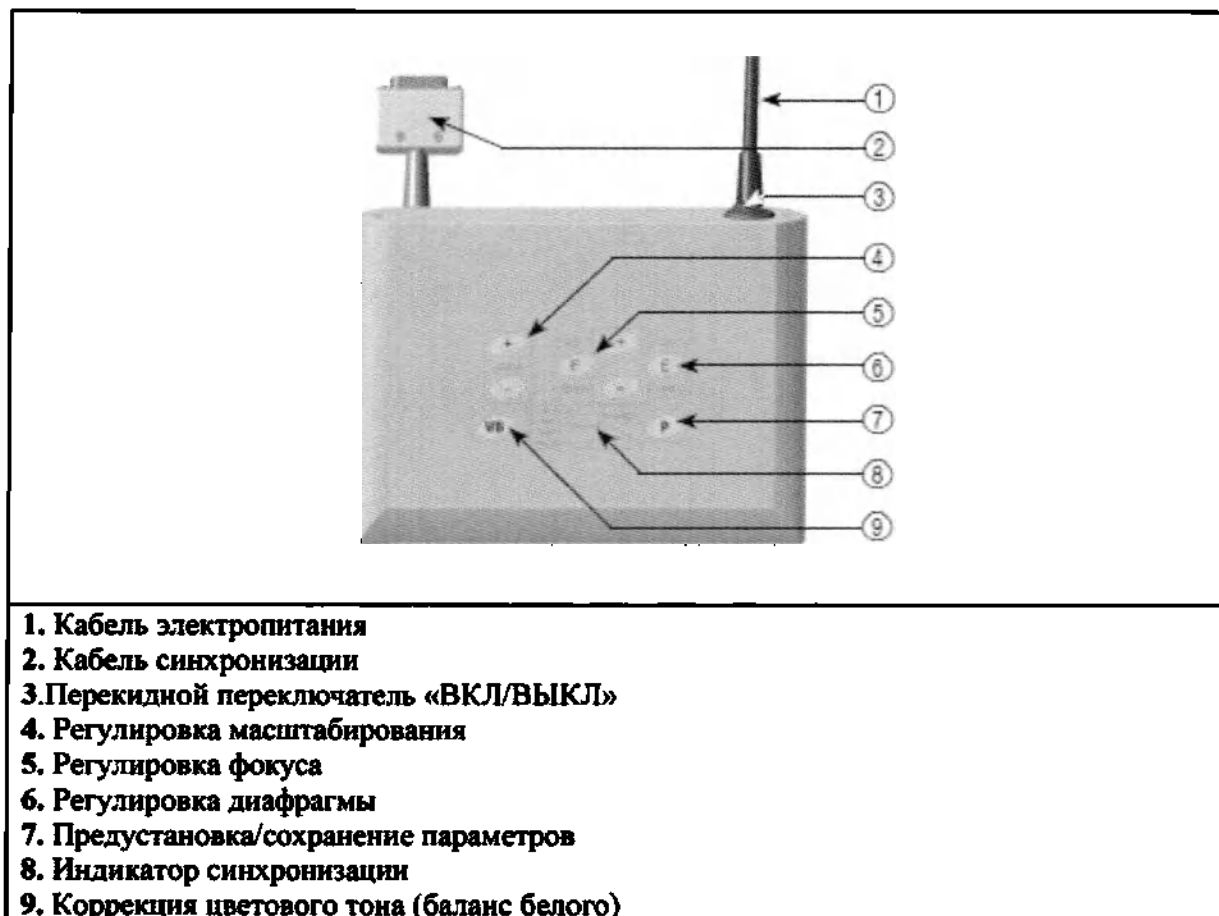
Рисунок 24 Панель дистанционного управления видеокамерой светильников LEDVISION 202/203
