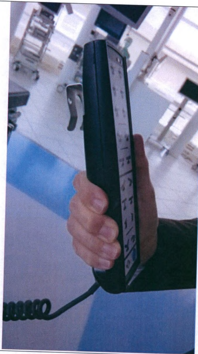
Пульт дистанционного управления подъемником, со спиральным кабелем (применим к вариантам исполнения: IV. Консоль жизнеобеспечения медицинская потолочная ORbiter 600X)
