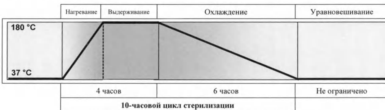
Рисунок: Изменение заданной температуры во время цикла стерилизации
