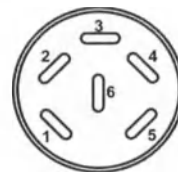
Рисунок: Конфигурация контактов DIN разъема (3) с задней стороны устройства
