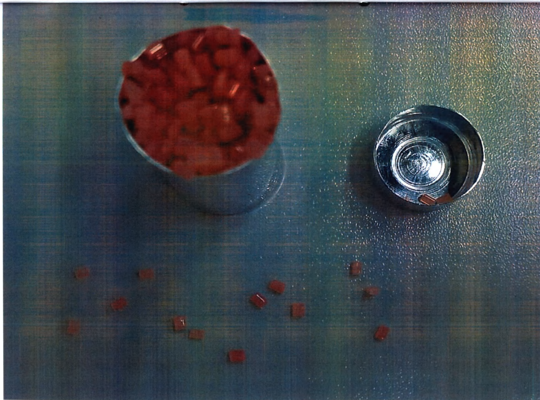
Материал термопластичный для изготовления съемных зубных протезов Villacryl Thermo Press в форме гранул в картридже
