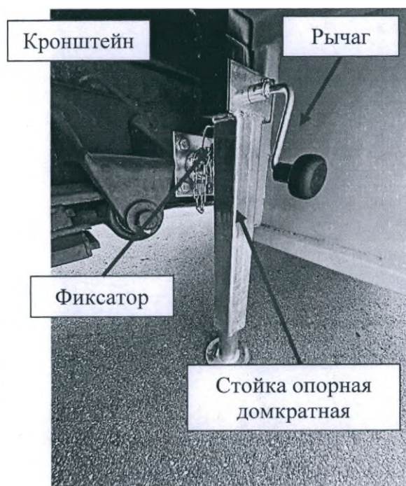
Рис.113 – Стойки опорные домкратные (рабочее положение)
