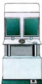
Рабочая станция системы сбора данных Mammomat Fusion: Рабочая консоль с экраном для защиты от радиоактивного излучения (дополнительно), ПК, монитором с плоским экраном, клавиатурой, мышью, блоком клавиш
