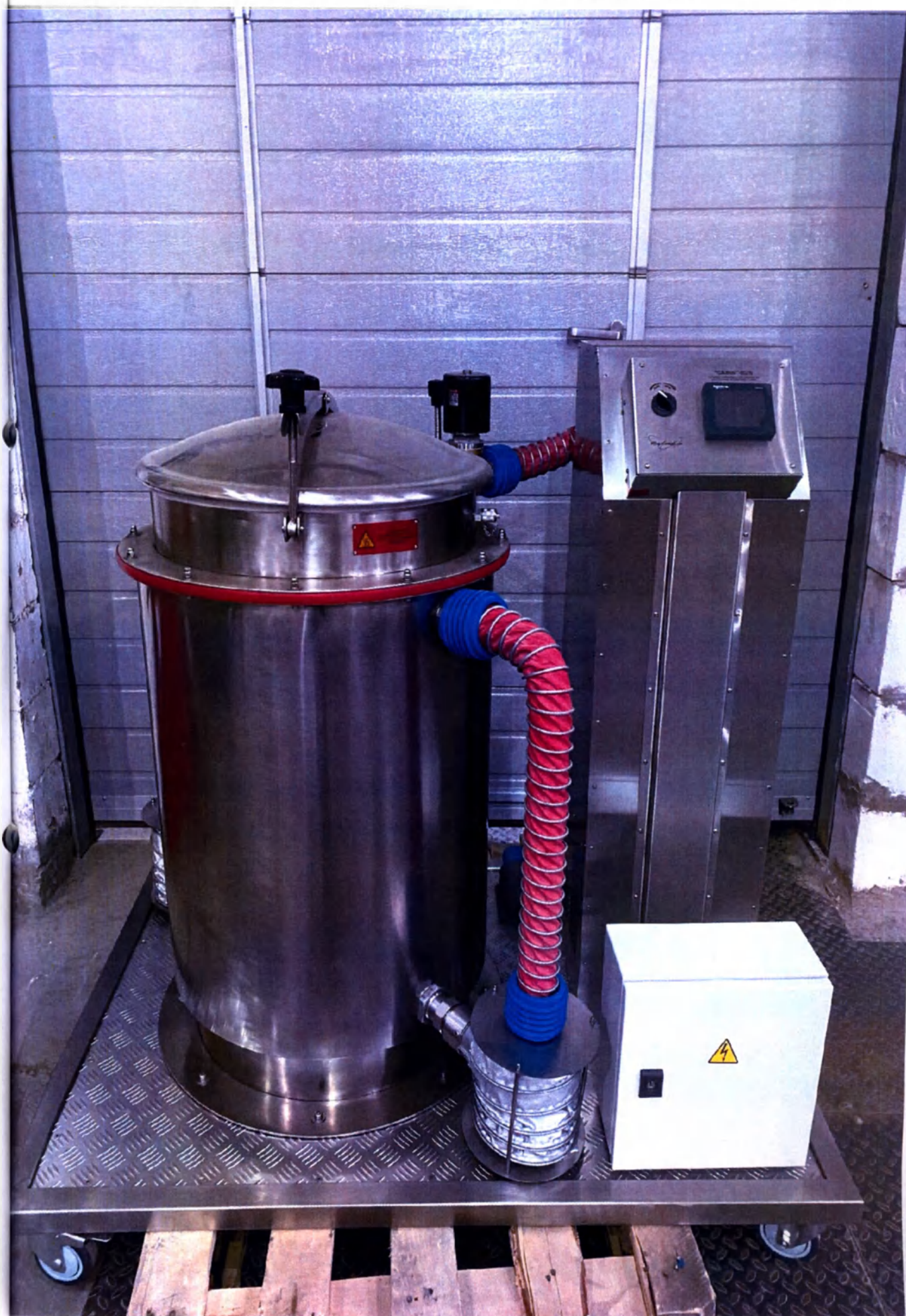
Фотографическое изображение Установка аппаратного обеззараживания/обезвреживания и деструкции медицинских отходов "САМот"-02/Б
