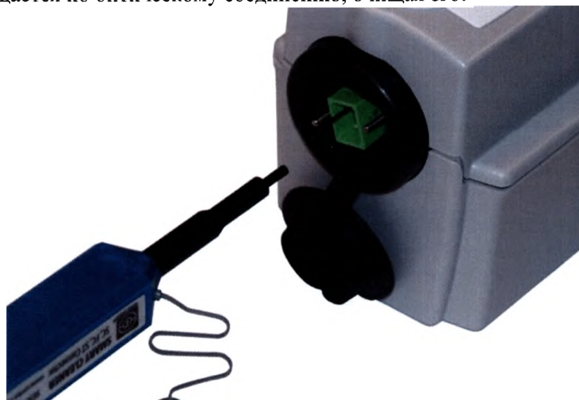
Рисунок 9-1. Вставление очистителя в оптический адаптер
