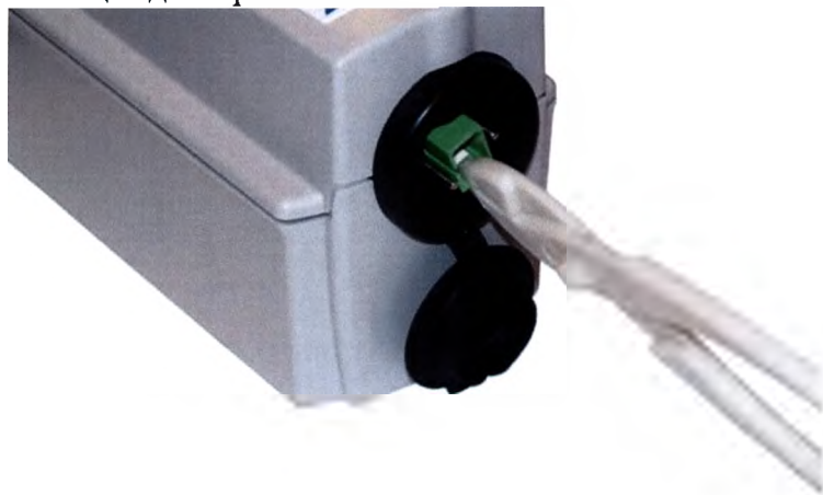
Рисунок 9-3: Правильный захват адаптера для извлечения
