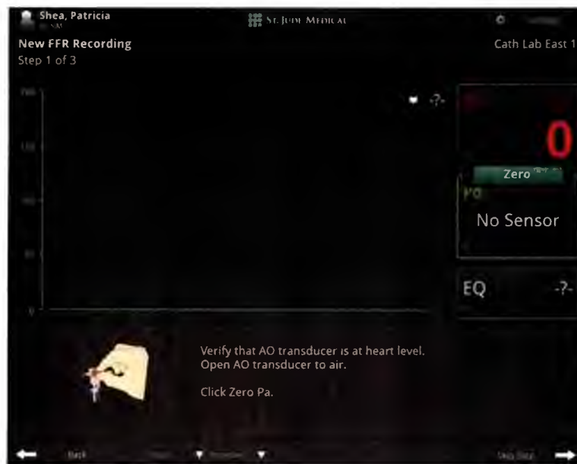
Рисунок 4-2: Инструкция установить высоту датчика внутриаортального давления и открыть датчик
