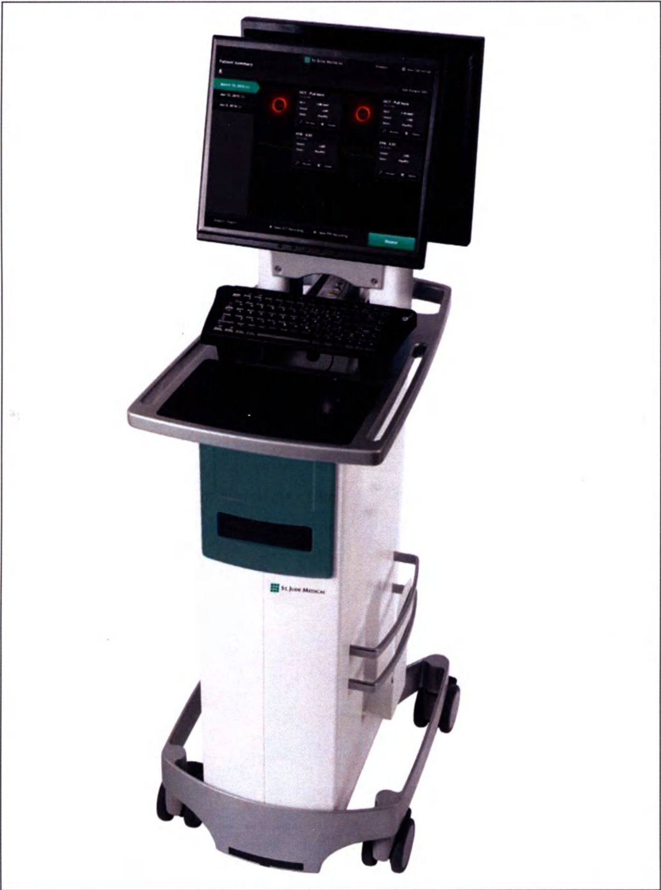
Система OPTIS Mobile для внутрисосудистой визуализации и внутрисосудистого измерения давления. Основной модуль-сойка оператора
