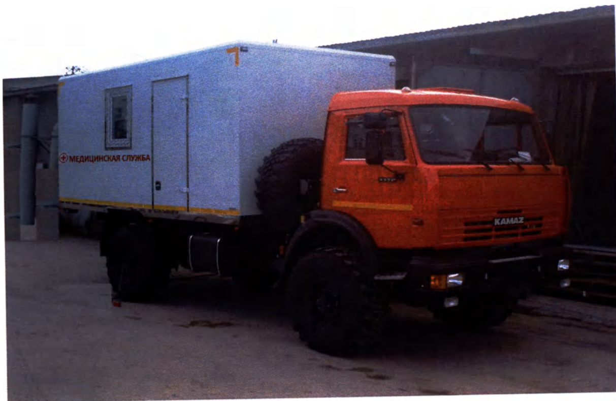
«КПФ-INVARIANT» на базе автомобиля типа 57532 шасси КАМАЗ 43502
