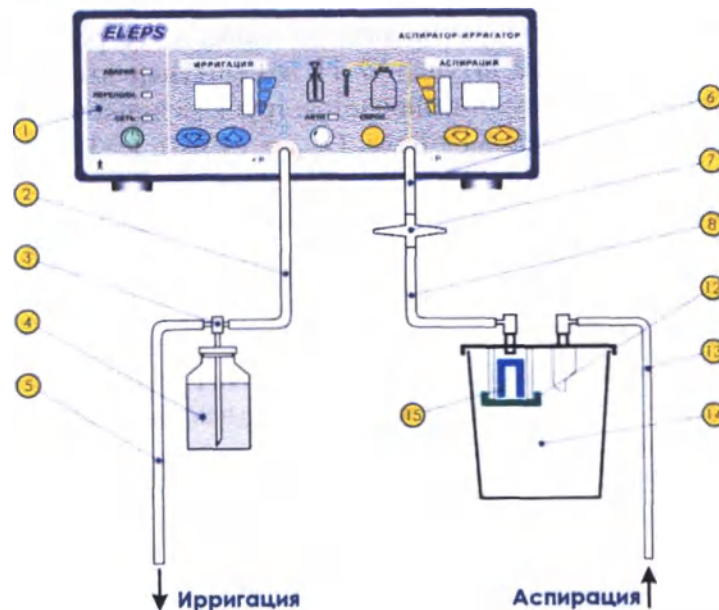
Рисунок 4. Схема подключения аспиратора-ирригатора с емкостью для секрета
