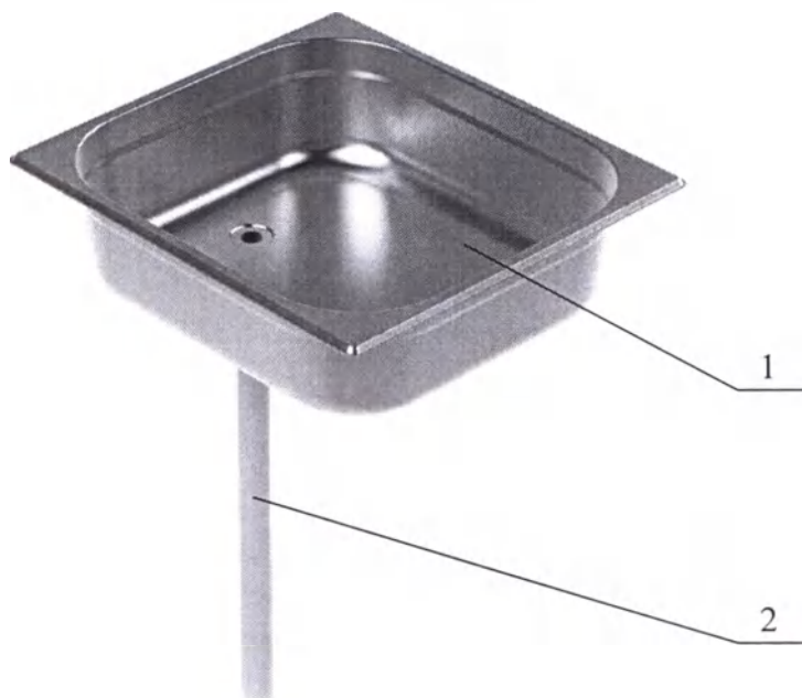
Рисунок 4. Ёмкость с дренажной системой.
