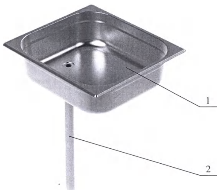
Рисунок 4. Ёмкость с дренажной системой.
