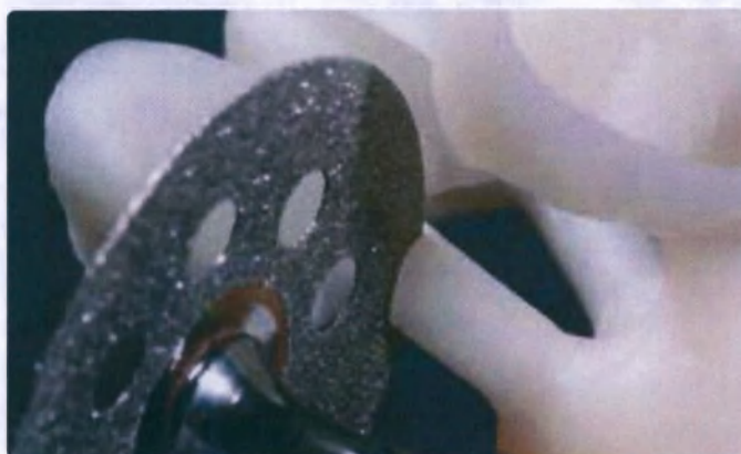
Отрезание литников с помощью тонкого алмазного диска, место отреза постоянно увлажняется
