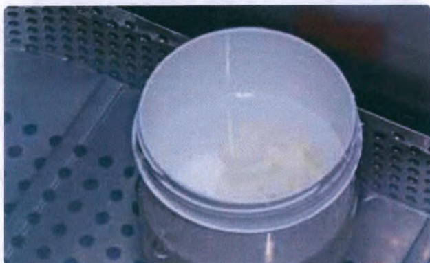
Удалите реакционный слой, образовавшийся на прессованных объектах, жидкостью Invex в ультразвуковой ванне.
