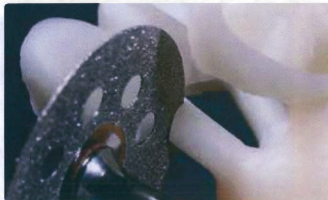
Отрезание литников в случае монохромной реставрации.
