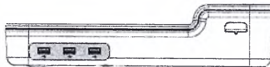
Рисунок 3. Правая панель ультразвукового процессора: разъемы USB (закрашены).
