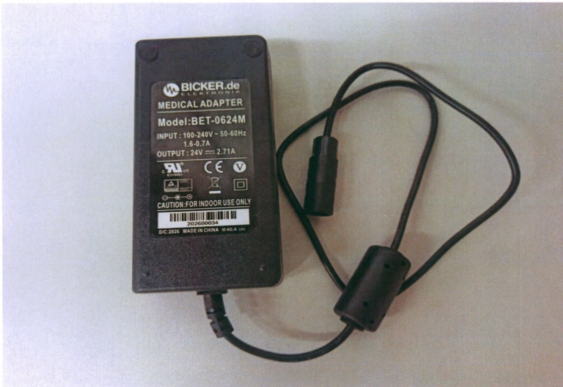
2. Блок электропитания (общий вид)
