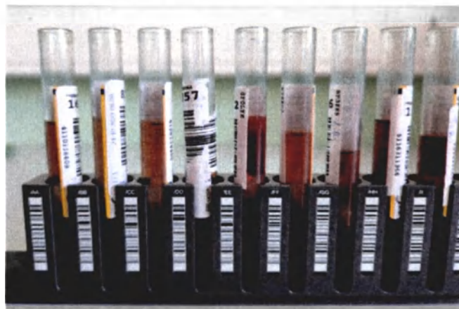
Рисунок 48 – Неправильное расположение пробирок в штативе
