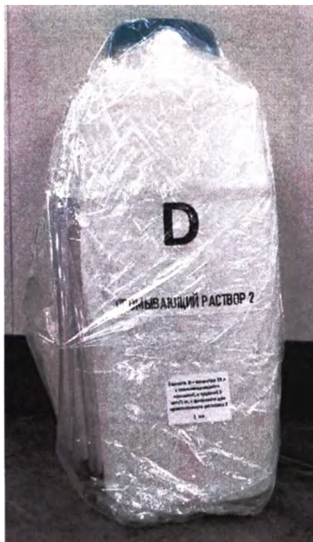
Рисунок 54 – Маркировка ёмкости D – канистра 15 л с завинчивающейся крышкой, с трубкой 5 мм/1 м, с фильтром для промывочного раствора 2
