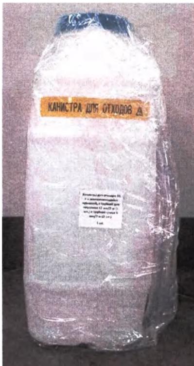
Рисунок 56 - Маркировка канистры для отходов 15 л с завинчивающейся крышкой, с трубкой для перелива 12 мм/2 м (1 шт.) и трубкой слива 5 мм/2 м (2 шт.)
