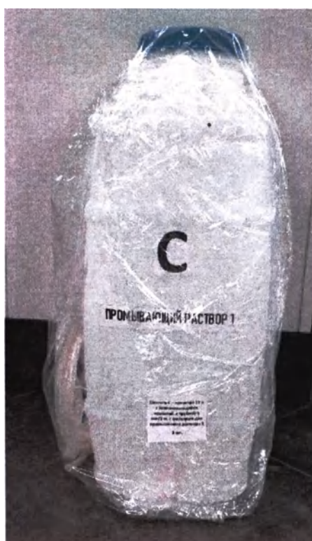
Рисунок 53 – Маркировка ёмкости С – канистра 15 л с завинчивающейся крышкой, с трубкой 5 мм/1 м, с фильтром для промывочного раствора 1
