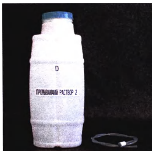
Рисунок 25 – Ёмкость D – канистра 15 л с завинчивающейся крышкой, с трубкой 5 мм/1 м, с фильтром для промывочного раствора 2
