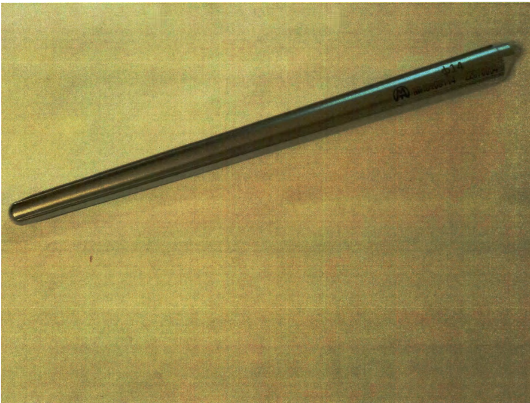
Рис. 14. Ножка примерочная дистальная М SL, под имплантат ножки бедренной ревизионной типоразмера 14
