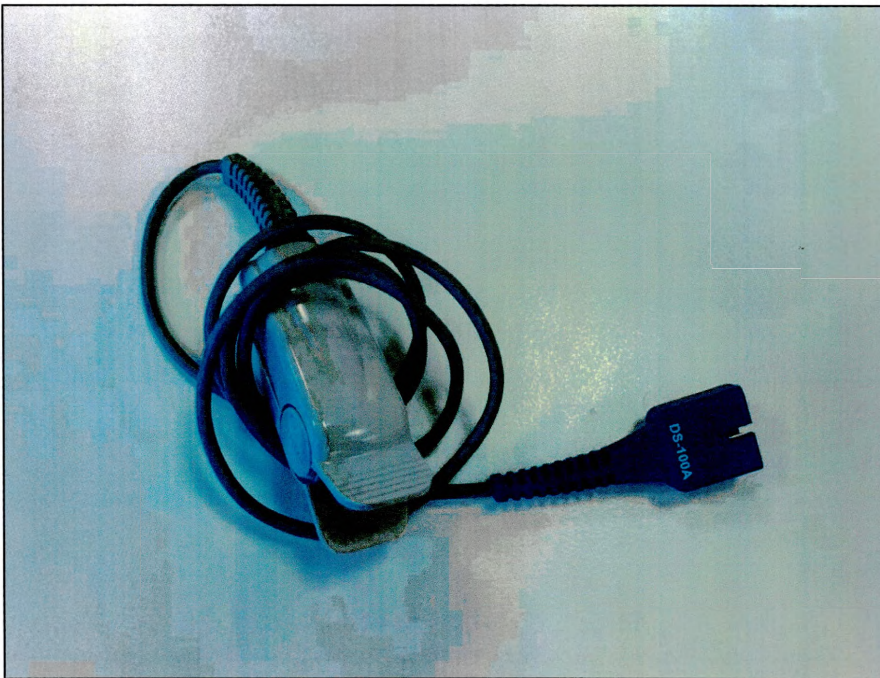
Датчик пульсоксиметрии многопалцевый Nellcor
