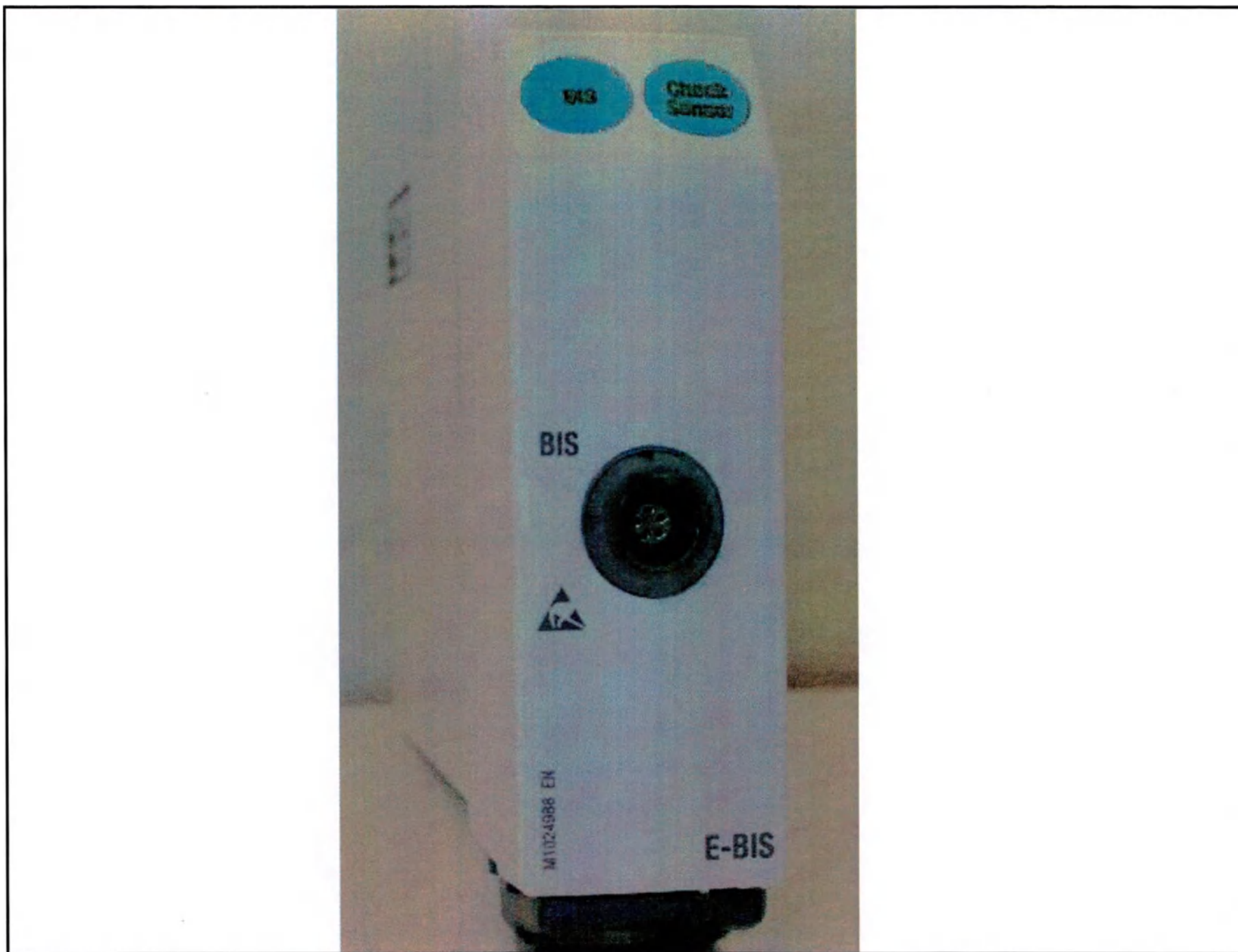
Модуль E-BIS мониторинга биспектрального индекса
