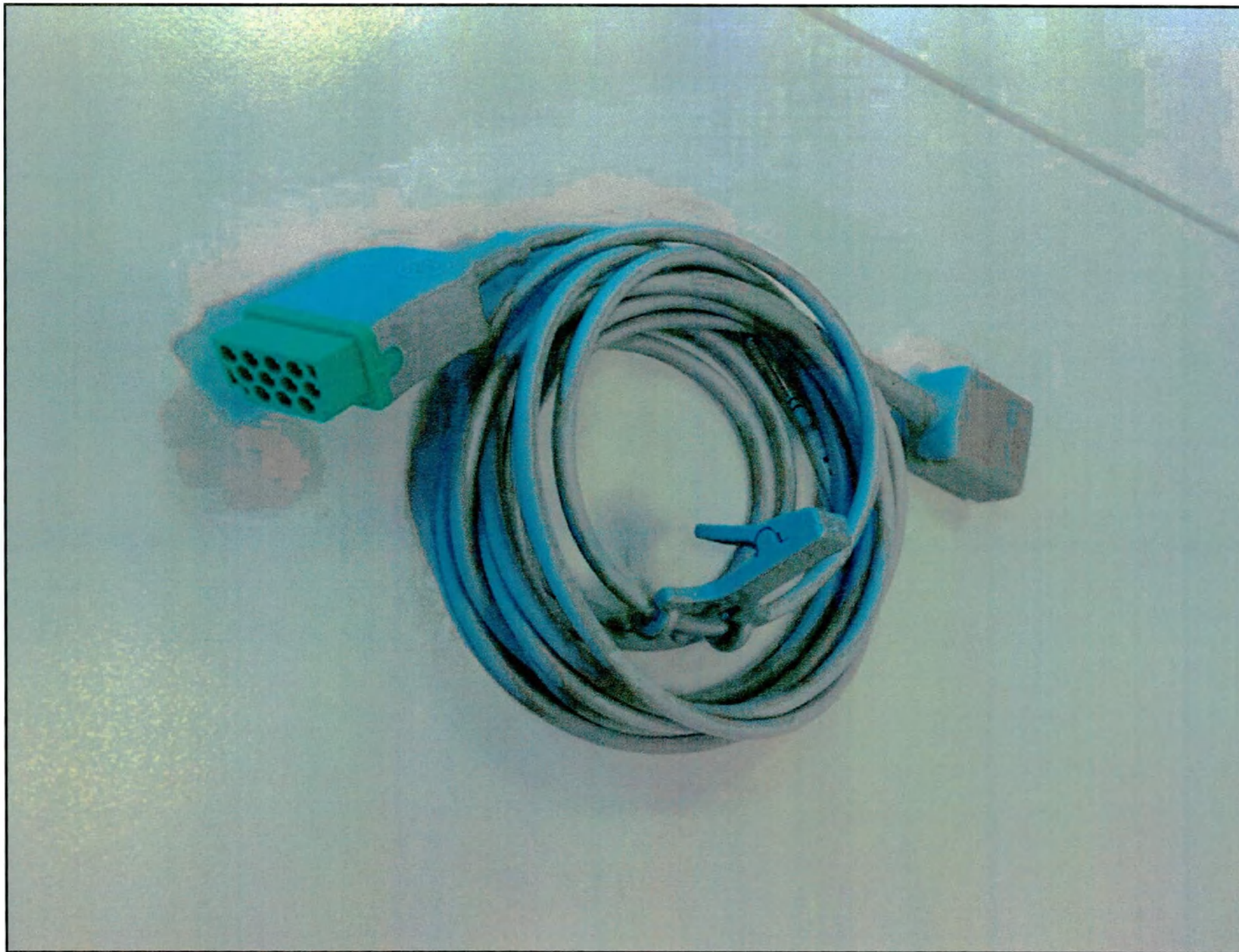
Кабель ЭКГ на 3/5 отведений, производства GE Healthcare Finland Oy
