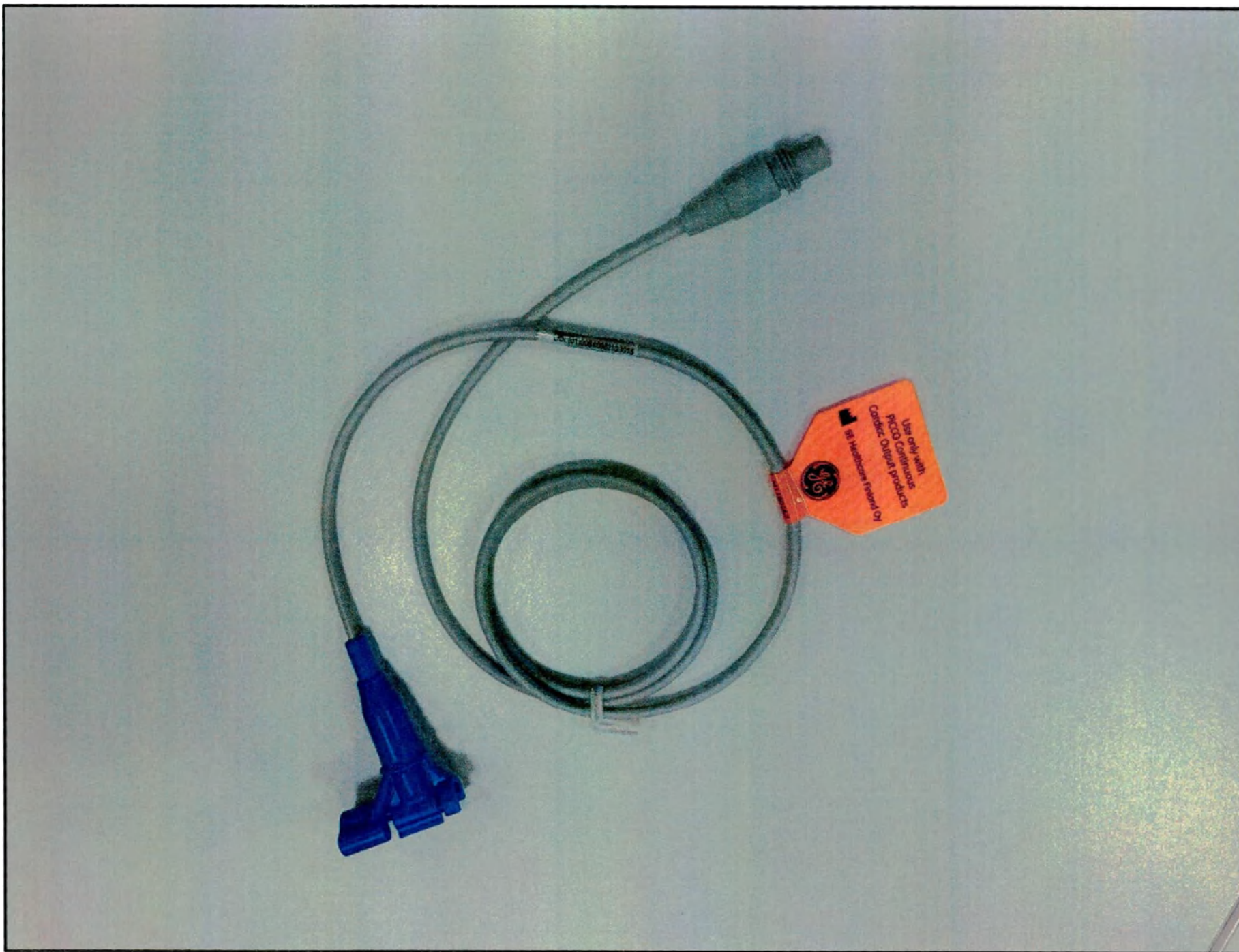
Кабель датчика температуры инжектата для модуля E-PICCO
