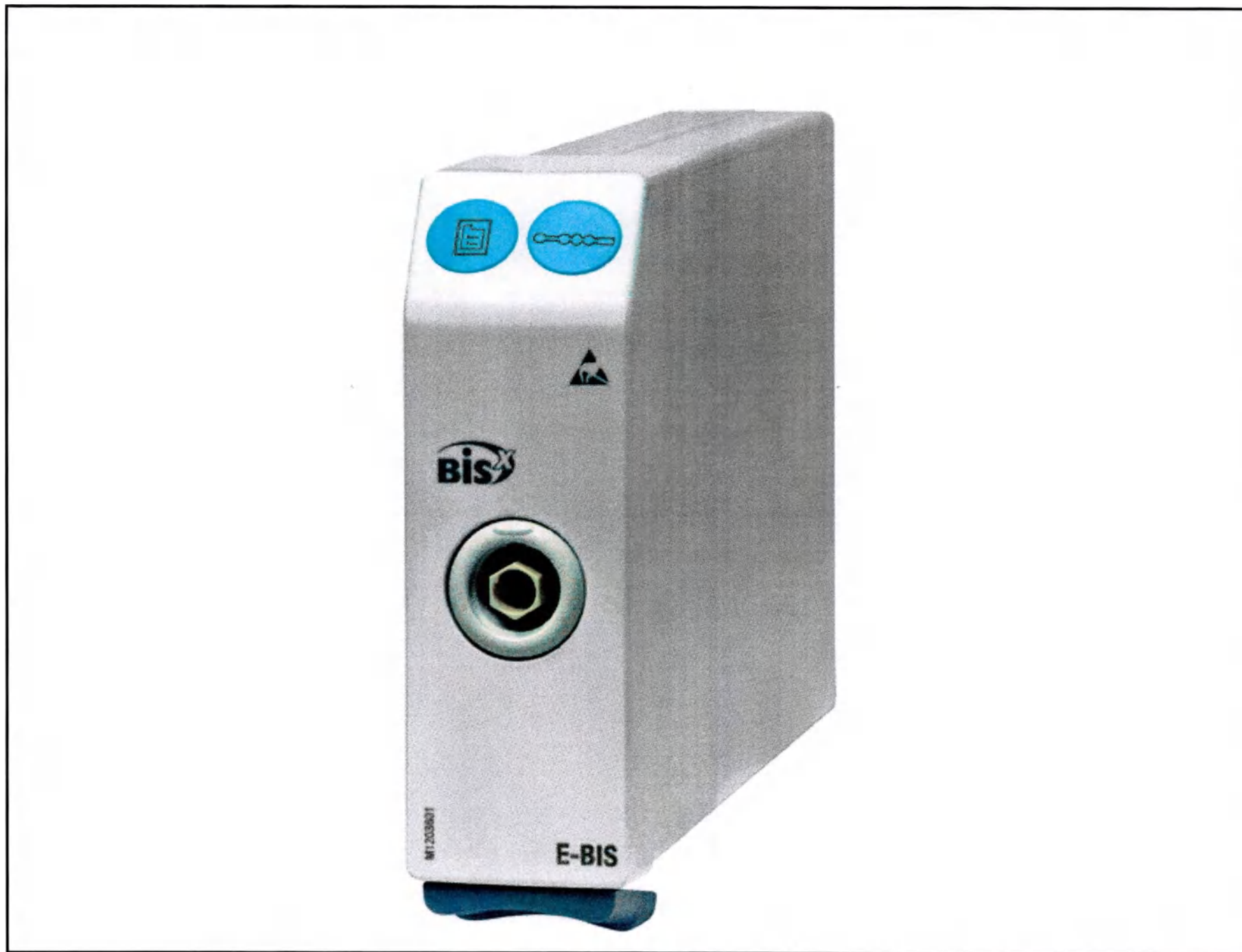
Модуль E-BIS мониторинга биспектрального индекса
