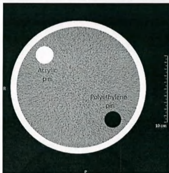
Физический слой фантома для измерения разрешения и толщины слоя (Проверка качества аксиальных двухмерных изображений головы)
