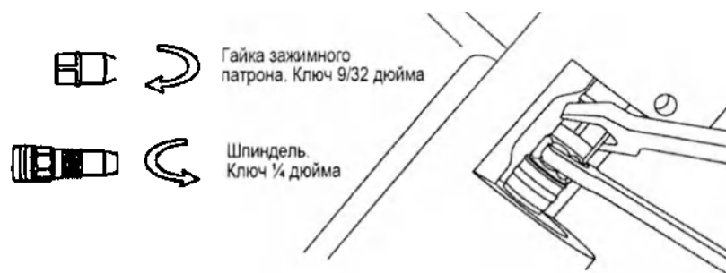
Рисунок 5-10. Установка датчика фрезы с шариковым наконечником
