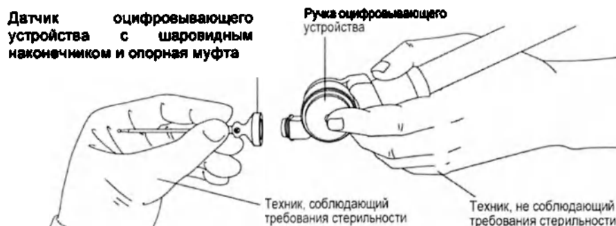
Рисунок 5-2. Установка стерильного шаровидного датчика оцифровывающего устройства и опорной муфты
