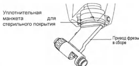
Рисунок 5-5. Установка покрытия на манипулятор
