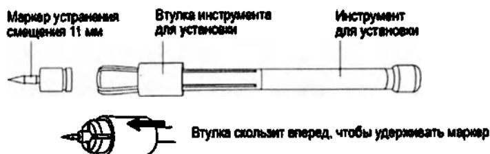
Рисунок 6-9 Маркер контроля смещения (11мм) и инструмент для его установки
