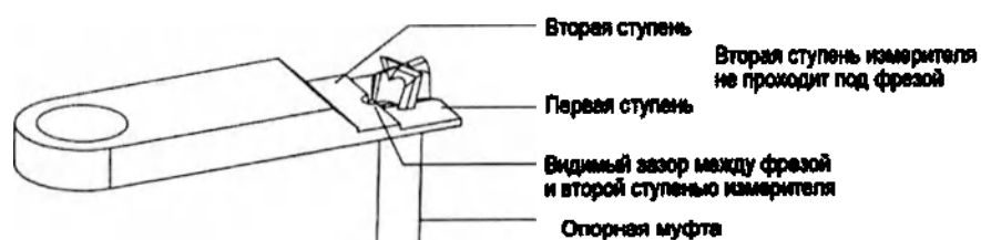
Рисунок 6-2 Правильная установка плоской фрезы
