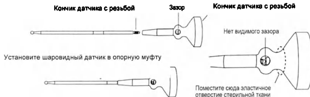
Рисунок 5-1. Датчик оцифровывающего устройства с шаровидным и троякарным наконечниками и опорная муфта датчика
