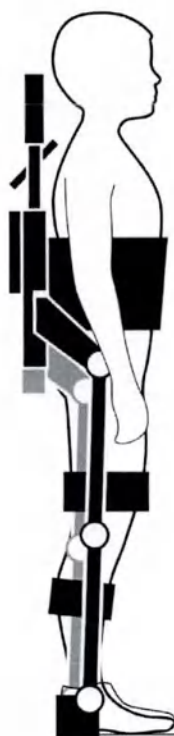
Рисунок 7-3 – Неправильно отрегулированы длины звеньев экзоскелета
