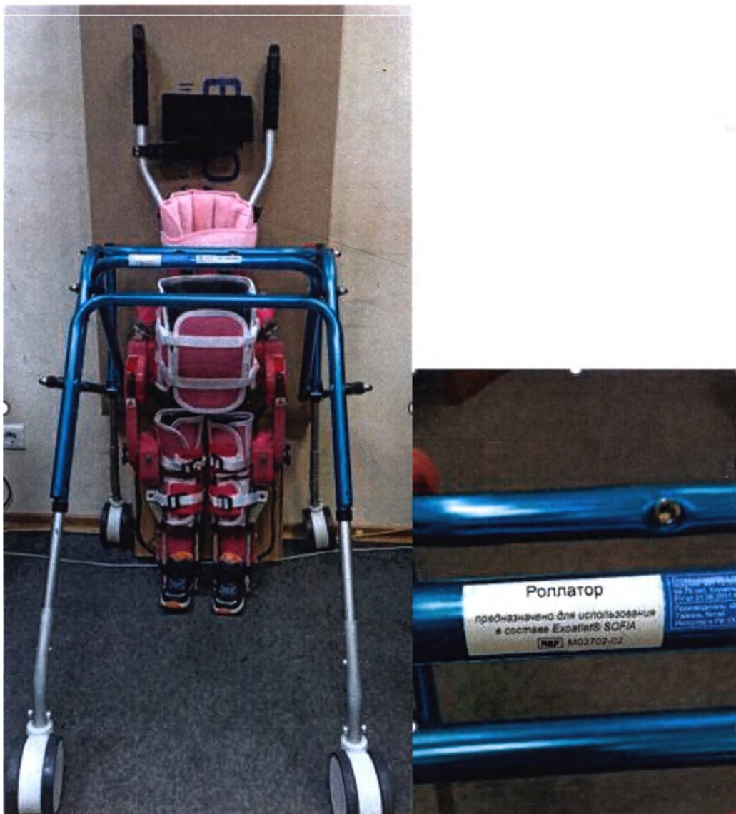
Рисунок 6 – Экзоскелет для реабилитации ExoAtlet® SOFIA с роллатором, держателем головы и блоком ФЭС с проводами и оценкой реабилитационного потенциала
