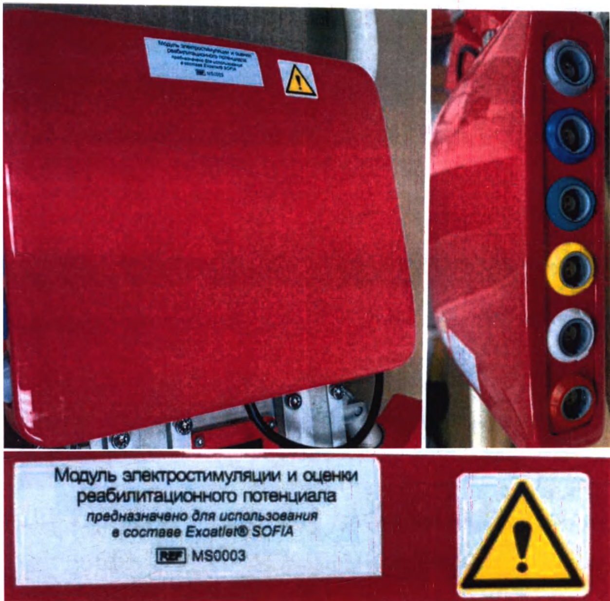
Рисунок 2 – Экзоскелет для реабилитации ExoAtlet® SOFIA с блоком ФЭС с проводами и оценкой реабилитационного потенциала.
