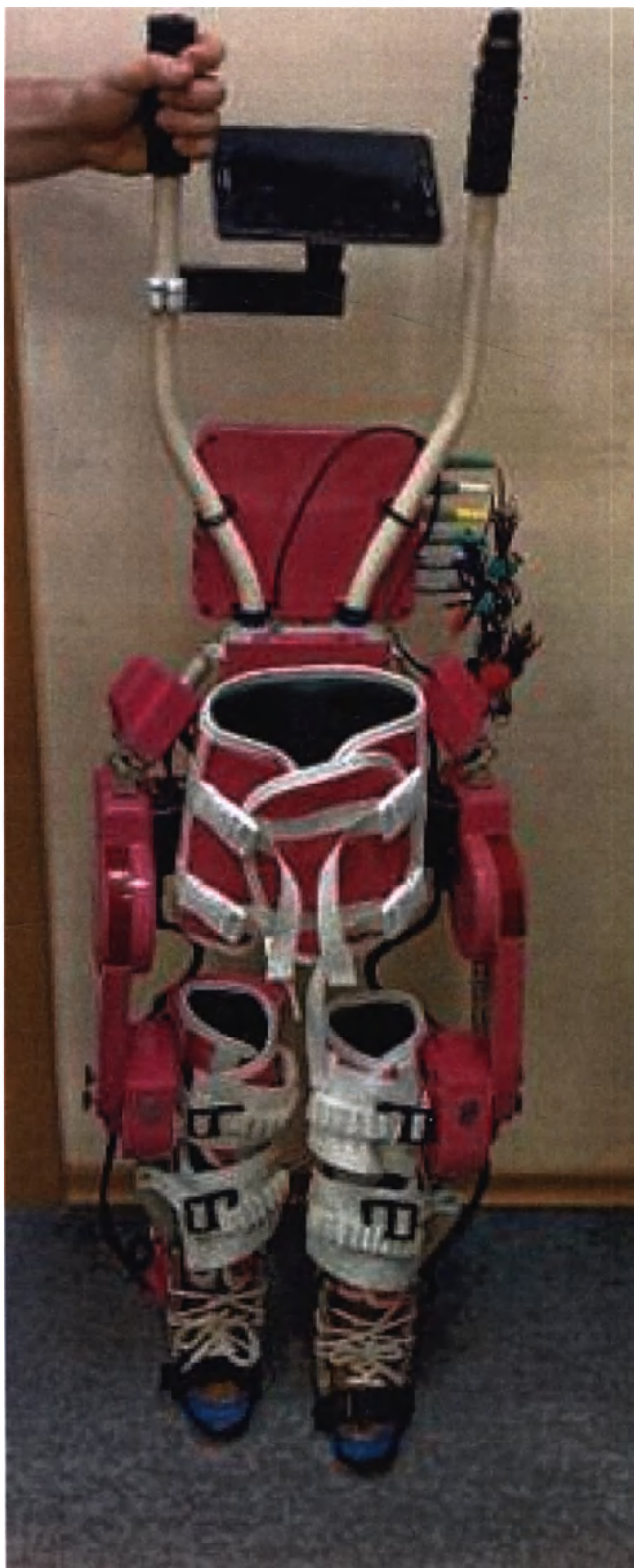
Рисунок 3 – Экзоскелет для реабилитации ExoAtlet® SOFIA. Планшетный компьютер и блок ФЭС с проводами и оценкой реабилитационного потенциала.
