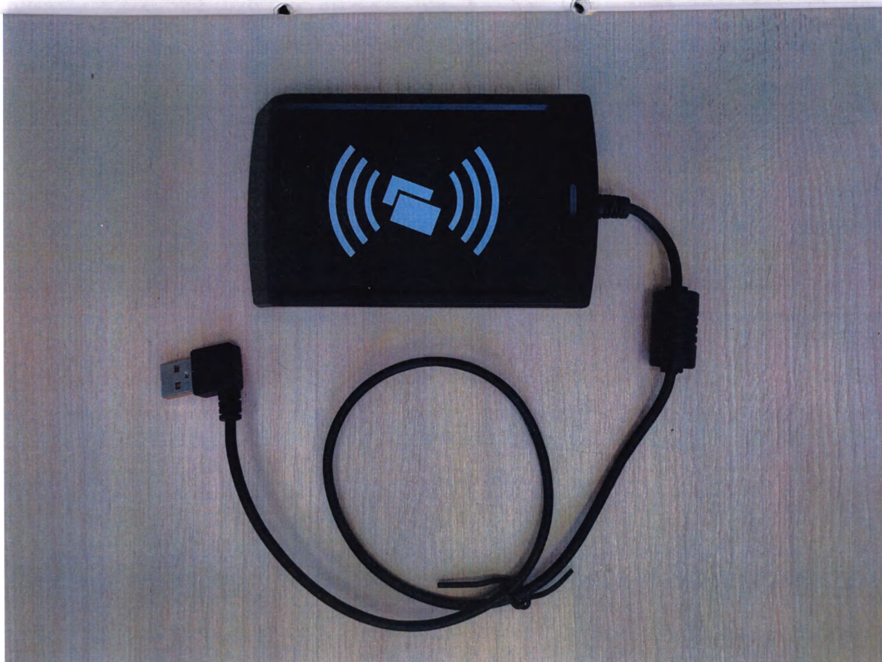
RFID-считыватель (Производитель: Shenzhen lai card technology Co., Ltd., торговая марка: Zybio, номер по каталогу: 02-54-00-7011-00)
