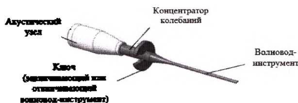
Рис. 5 Схема подсоединения или отсоединения волновода-инструмента
