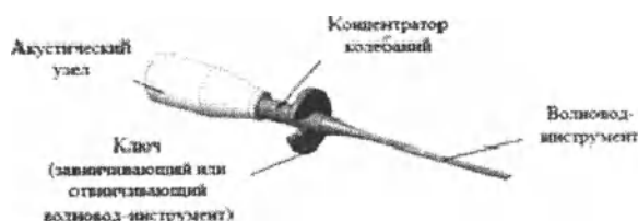
Рис. 5 Схема подсоединения или отсоединения волновода-инструмента
