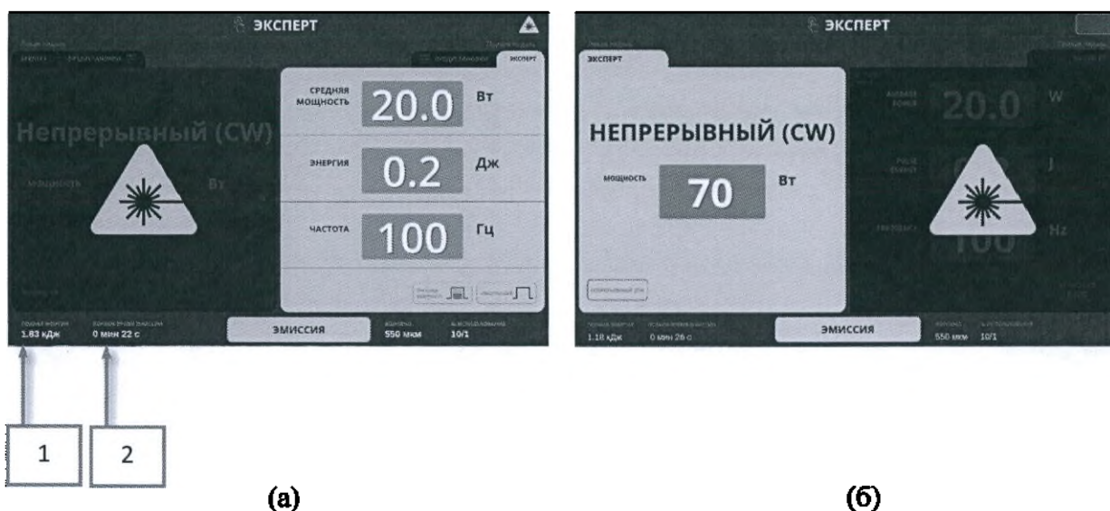
Рис. 24 - Эмиссия лазерного излучения: (а) при нажатии на правую педаль; (б) при нажатии на левую педаль
