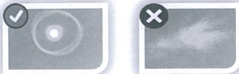
Рис. 12- Проверка дистального конца инструмента волоконного инструмента с торцевым выходом
