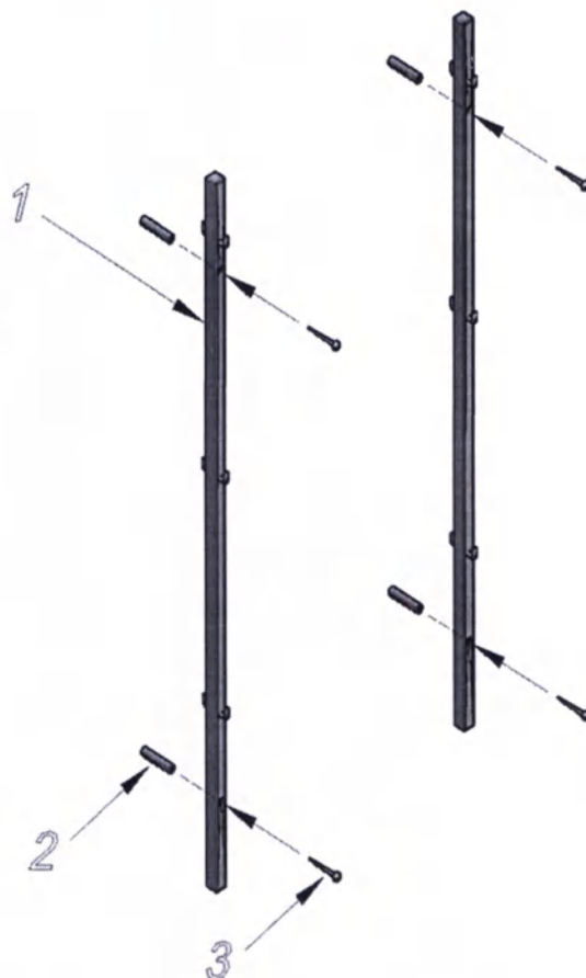
Рисунок 12 Схема монтажа настенных шин с кронштейнами для корзин НШК-«МЕДИКОН»
