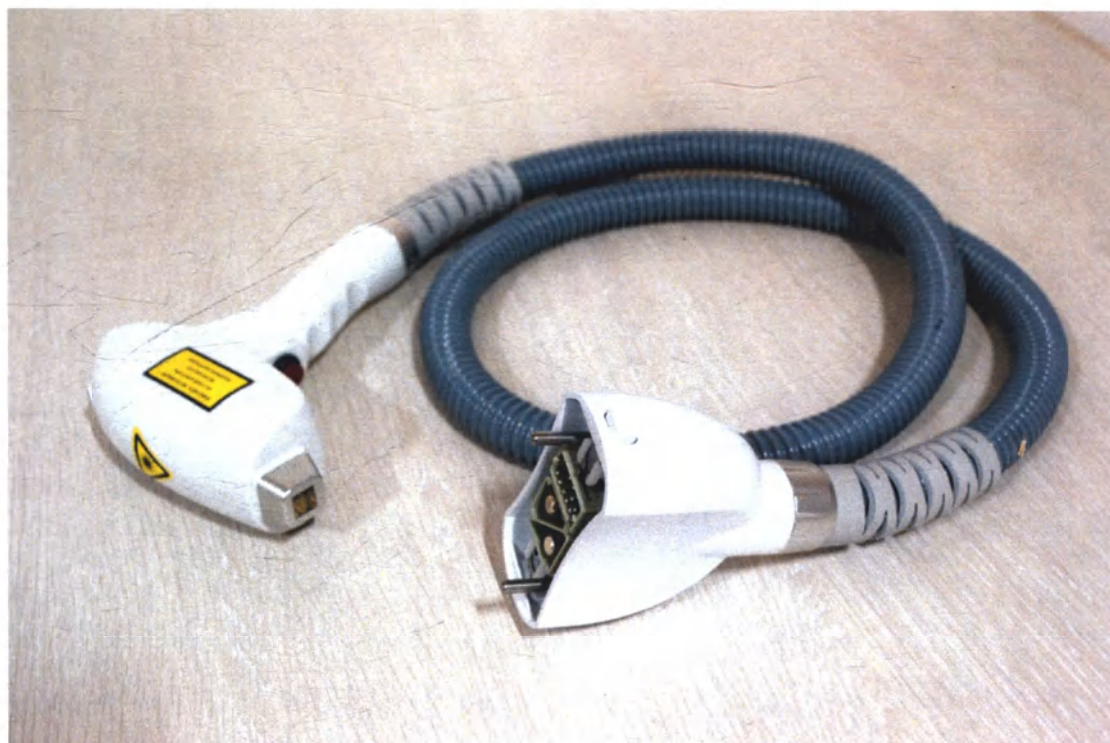
Рукоятка источника с кабелем и разъемом (коннектором) аппарата In-Motion D2
