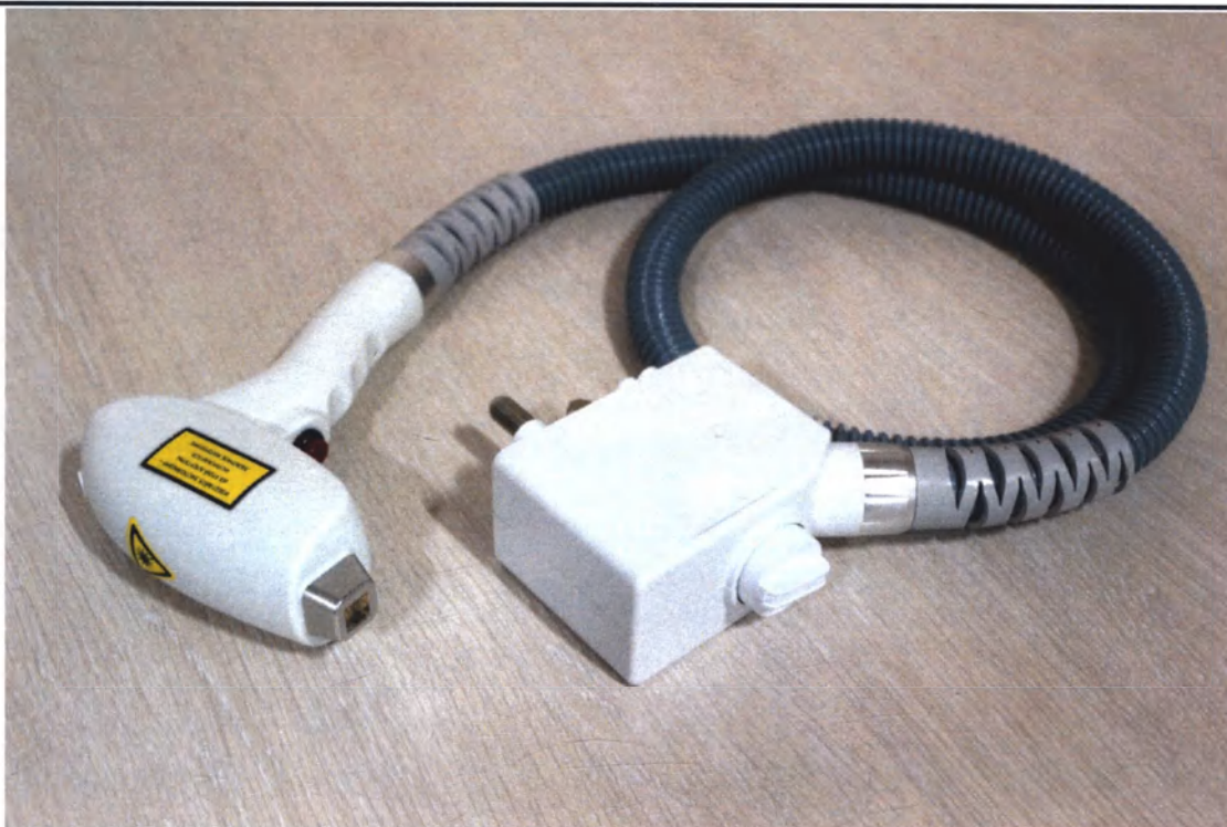
Рукоятка источника с кабелем и разъемом (коннектором) аппарата In-Motion D1
