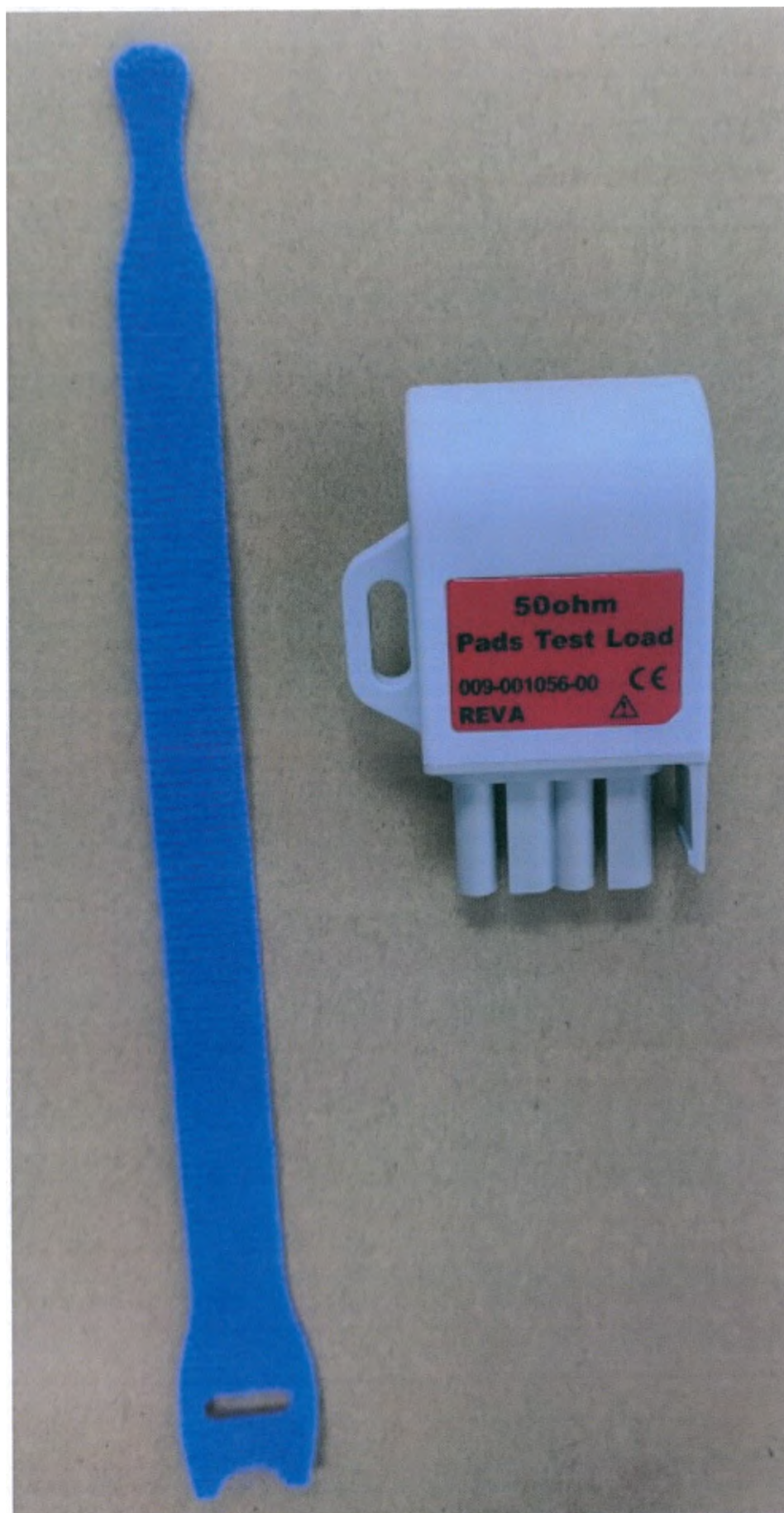
Нагрузка испытательная для удлинительного кабеля электродов. Общий вид
