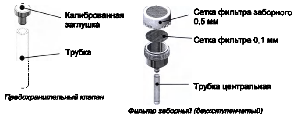
Рис.23 Предохранительный клапан и Фильтр заборный (двухступенчатый)
