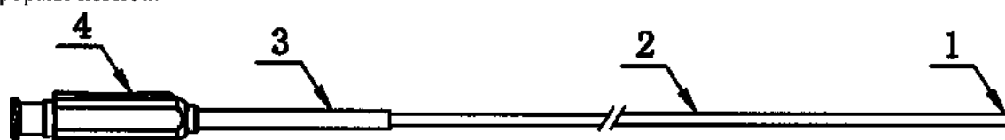
(1 - наконечник; 2 - трубка катетера (shaft); 3 - разгрузочная муфта; 4 - канюля)
